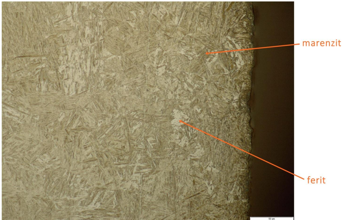
Slika 34. Mikrostruktura uzorka 2 u nagiženom stanju, povećanje 500x
