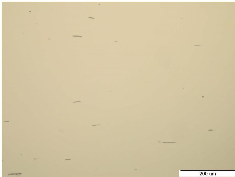
Slika 23. Polirana površina uzorka, uzdužni presjek
