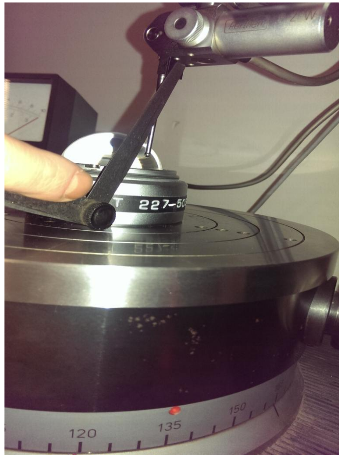
Slika 35. Osiguranje kuta ticala mjernim listićima
