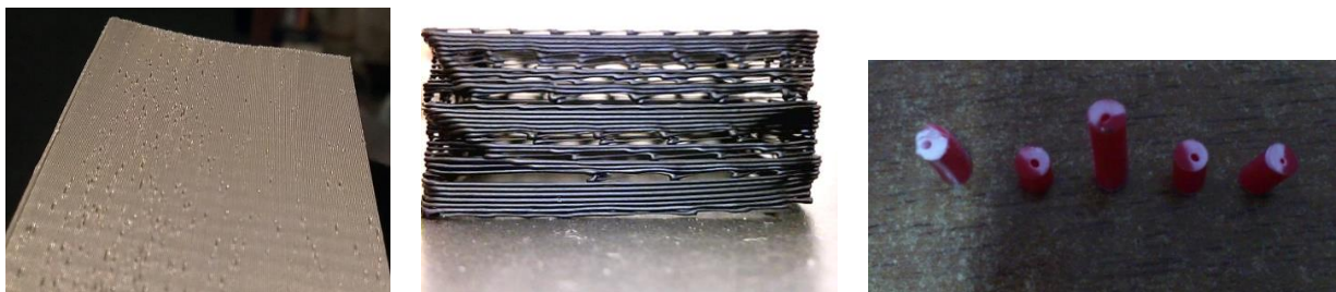
Slika 3.2 Greške kod neadekvatnog rukovanja materijalom: a) Rupice u materijalu [8], b) Nepravilno taljenje materijala [9], c) Rupice u tvorevini [10]
