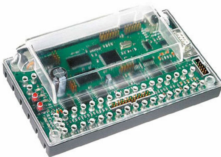
Slika 4.4. Fotografija upravljačkog sučelja „Fischertechnik Robo interface“ [10]
