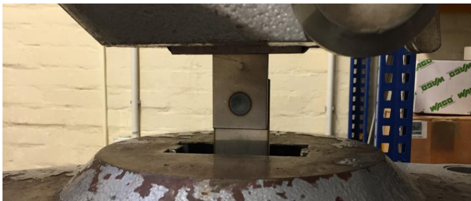
Slika 45. Uzorak stegnut u čeljusti kidalice
