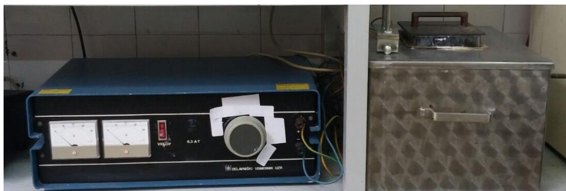
Slika 48. Oprema za elektrokemijsko nagrizanje
