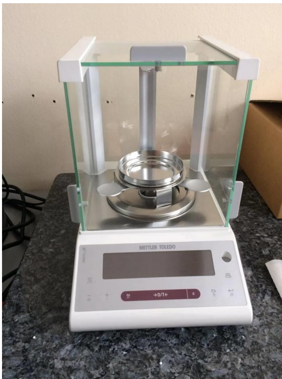
Slika 7.3 Uređaj za mjerenje Arhimedove gustoće
