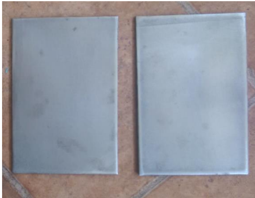
Slika 16. 1. grupa uzoraka (očišćeni i odmašćeni)
