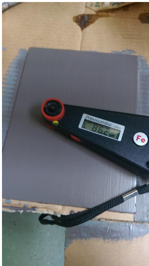
Slika 20. Mjerenje debljine suhog filma uređajem QuaNix 1500
