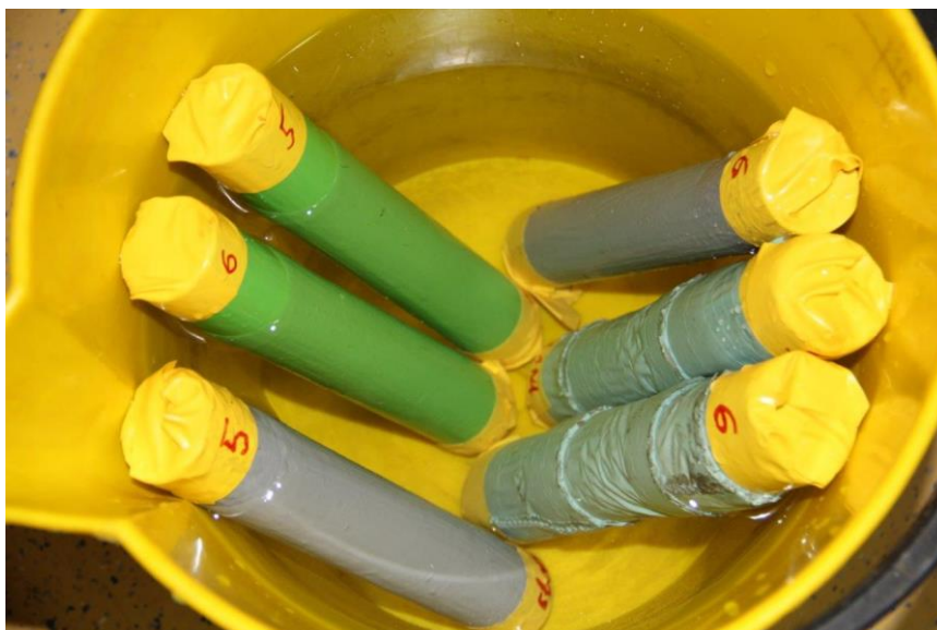
Slika 23. Ispitivanje u vodenoj otopini 3,5 % NaCl
