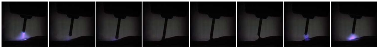
Slika 16. Slijed odvajanja kapljice kod CMT postupka [14]
