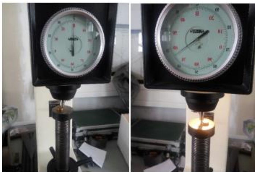
Slika 6.1. Ispitivanje adhezivnosti na Rockwell-ovom tvrdomjeru [18]
