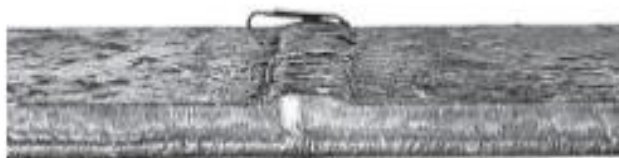
Slika 6. Sučeljeni „V“ zavar 1 [7]
