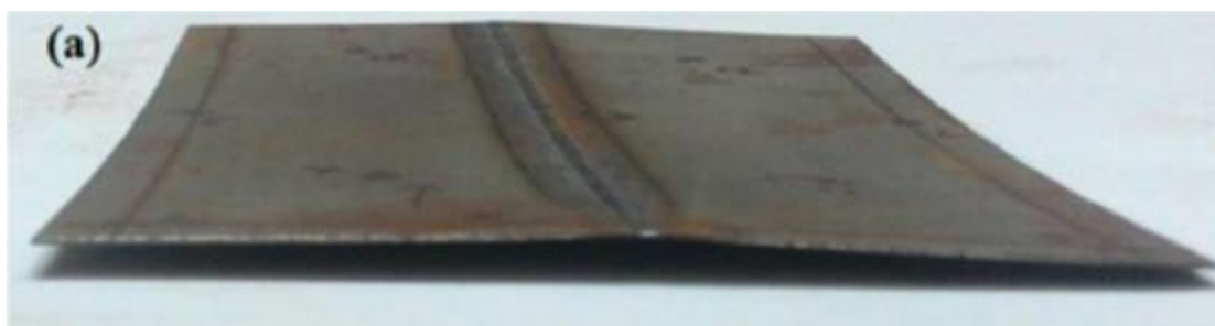
Slika 18. Realni primjer iskrivljenja [11]
