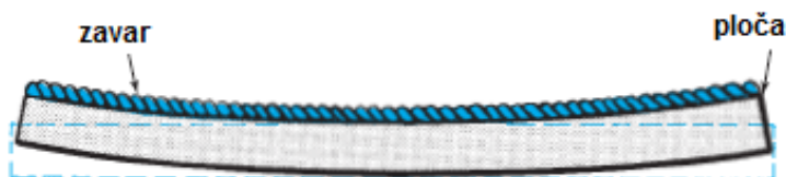
Slika 8. Shematski prikaz savijanja [7]
