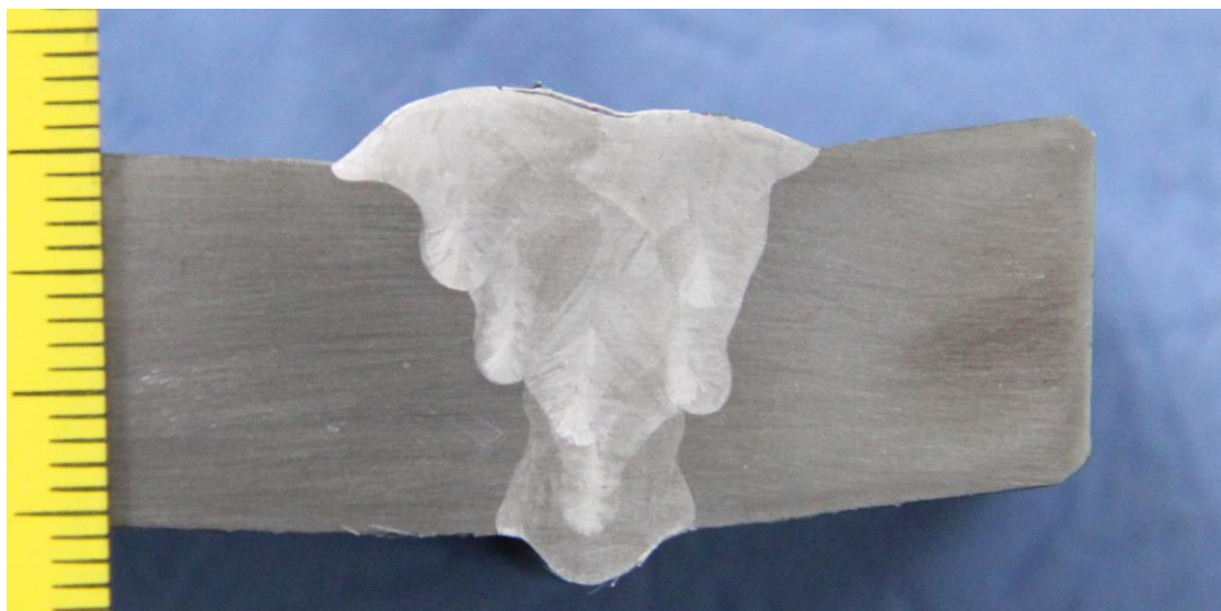
Slika 51. Makroizbrusak 2 ( Lincoln MIG 309LSi dodatni materijal)
