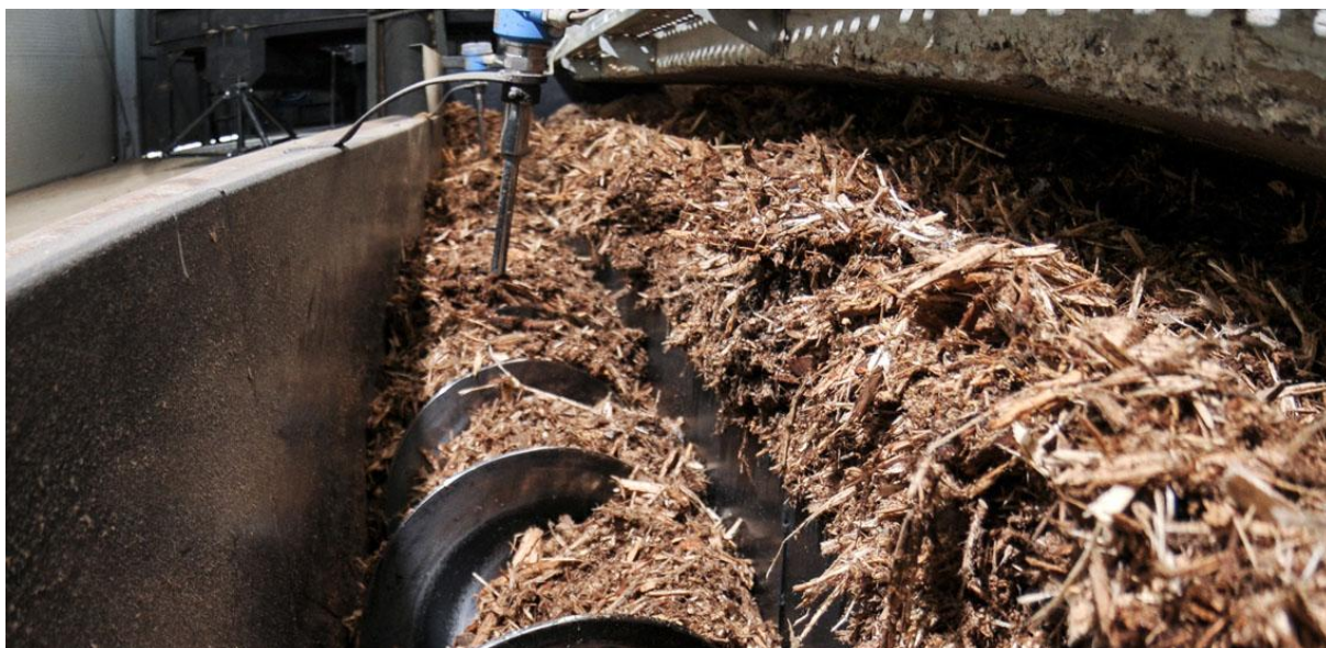
Slika 6. Prijenos biomase pužnim vijcima [7]
