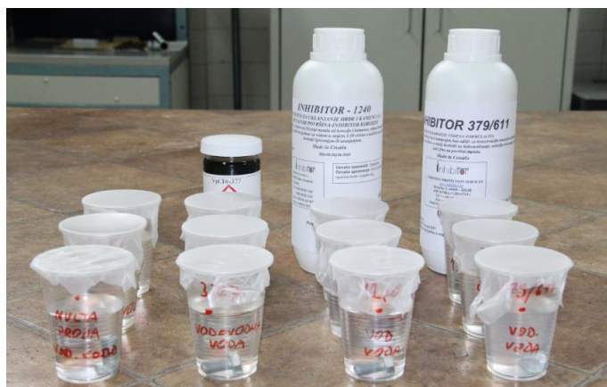
Slika 14. Prikaz uzoraka nakon uranjanja u posudice vodovodne vode, destilirane vode, te otopine NaCl-a s inhibitorima korozije
