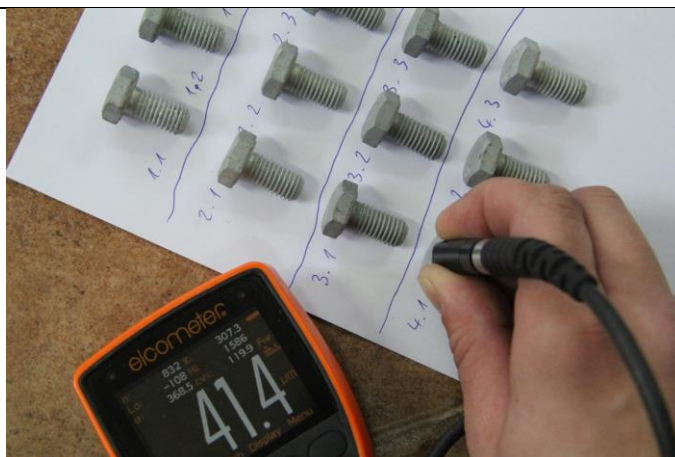
Slika 13. Mjerenje debljine prevlake cinka uređajem ELCOMETER 456/4
