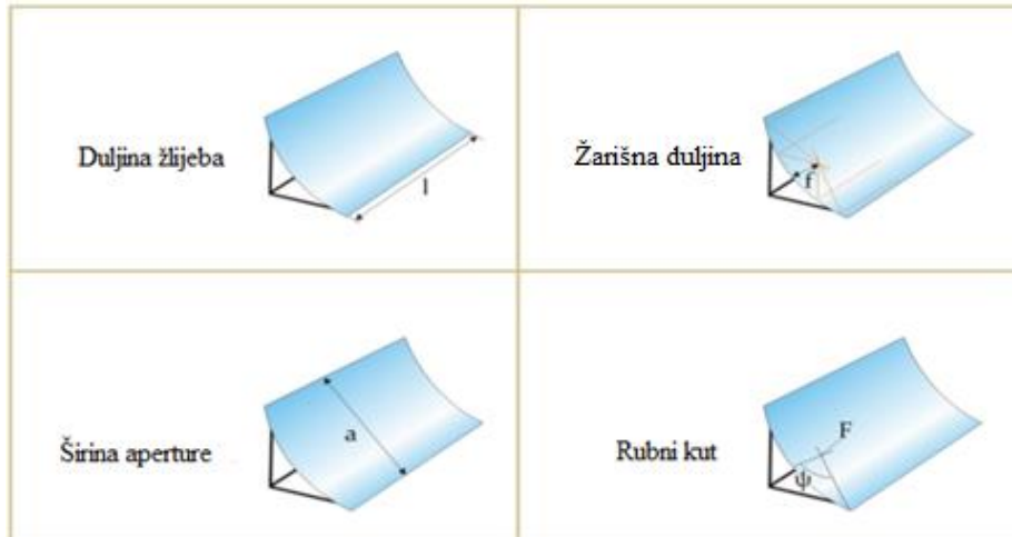
Slika 19. Geometrijski parametri paraboličnog žljebastog kolektora
