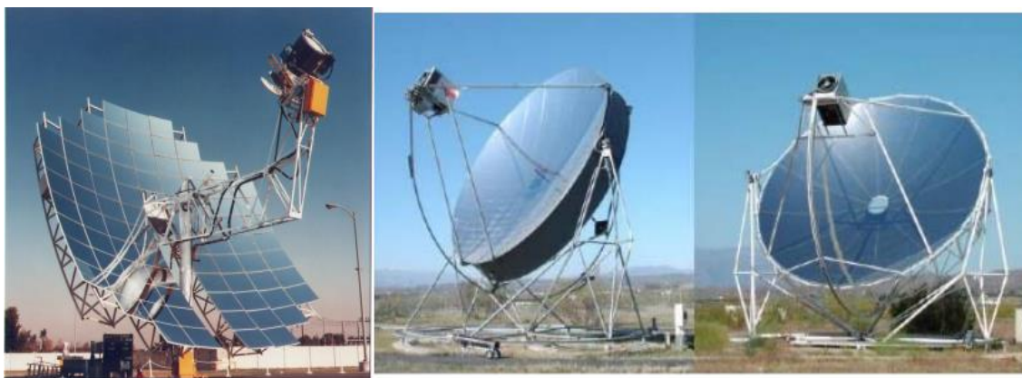
Slika 30. Različite izvedbe paraboloidnog kolektora
