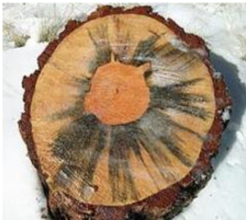
Slika 20. Gljivice na poprečnom presjeku drva, [10]
