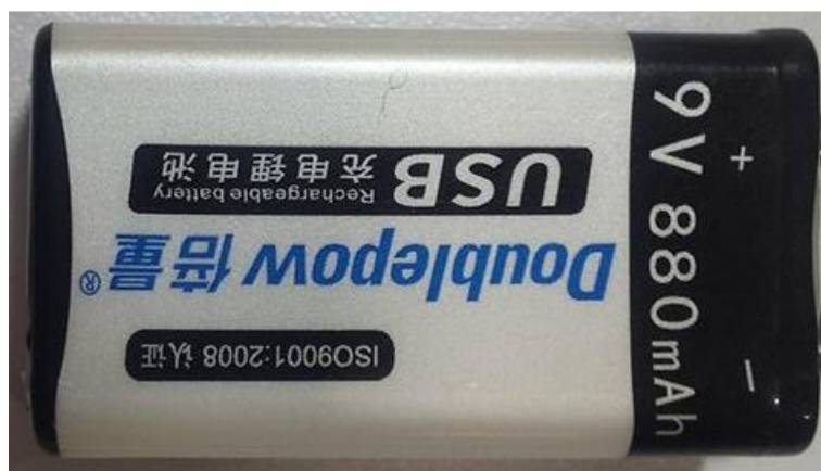
Slika 33. Baterija Doublepow 9V 880mAh (pogled od naprijed)
