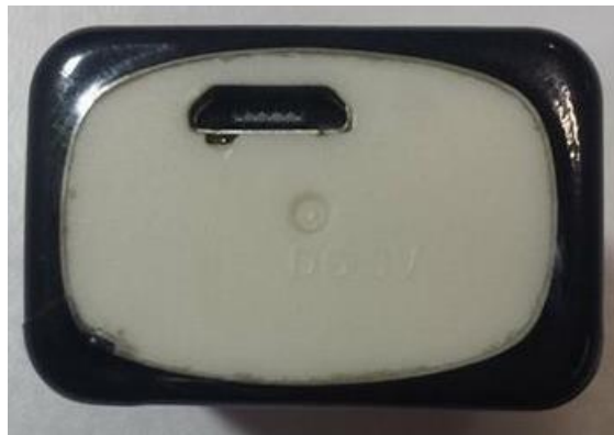
Slika 32. Baterija Doublepow 9V 880 mAh (pogled od ispod)
