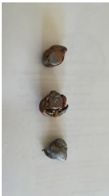
Slika 8.11. Primjeri zrna nakon udarca u metu
