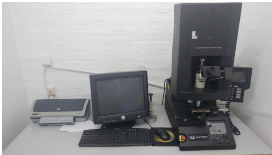
Slika 8.9. Mjerenje tvrdoće na uređaju Wilson Volpert Tukon 2100 b
