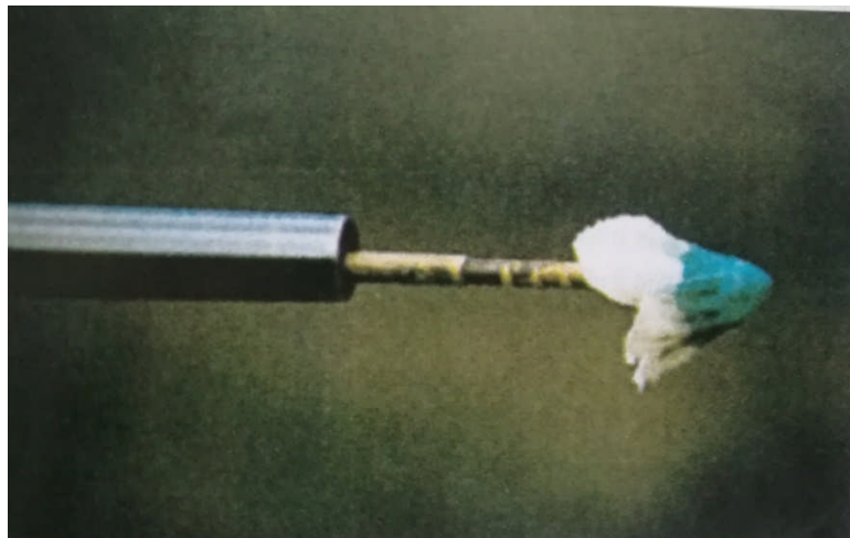
Slika 7.1. Obojena krpica pokazatelj prisustva nečistoća u cijevi [14]
