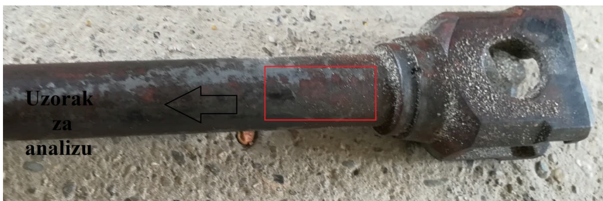
Slika 8.4. Uzimanje uzoraka cijevi lovačkog oružja
