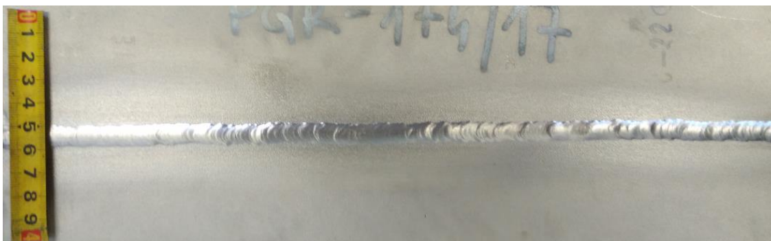
Slika 29. Popravak korijenskog prolaza sa suprotne strane
