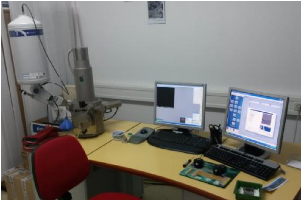
Slika 41. Tescan Vega TS5136 – Pretražni elektronski mikroskop (SEM)
