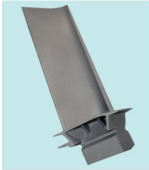
Slika 19. Lopatica visokotlačne turbine mlaznog motora [27]
