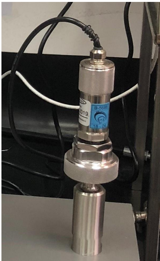
Slika 11. WIKA P-30 električni pretvornik
