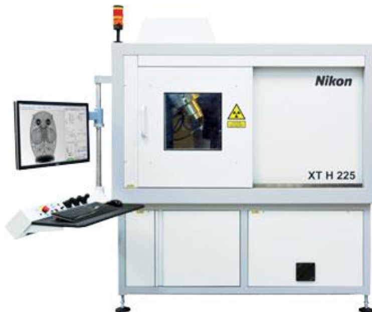
Slika 24. Industrijski CT uređaj korišten za eksperiment [27].
