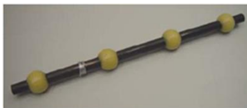
Slika 17. Primjer objekata koji se koriste za kalibraciju [1].
