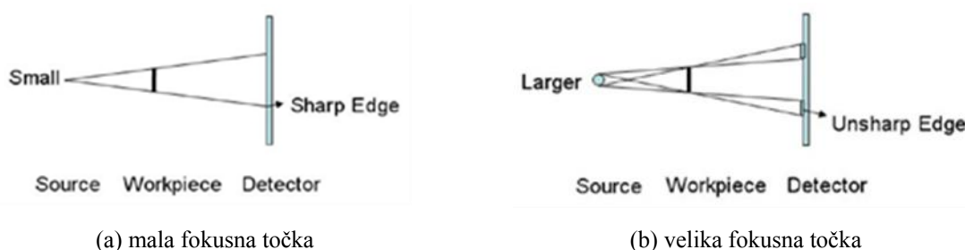
Slika 13. Efekt fokusne točke [1].
