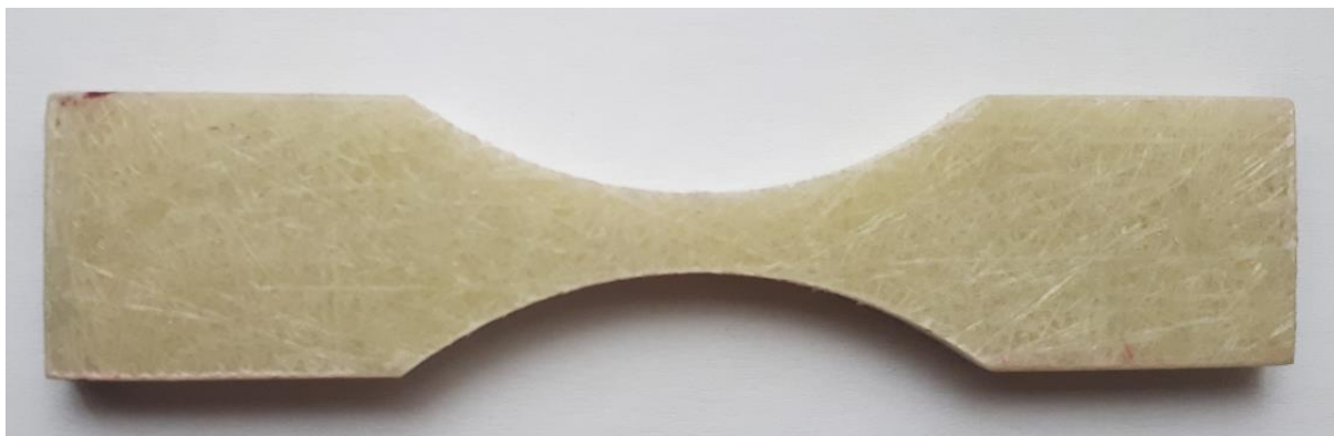
Slika 23. Uzorak za vlačno ispitivanje.
