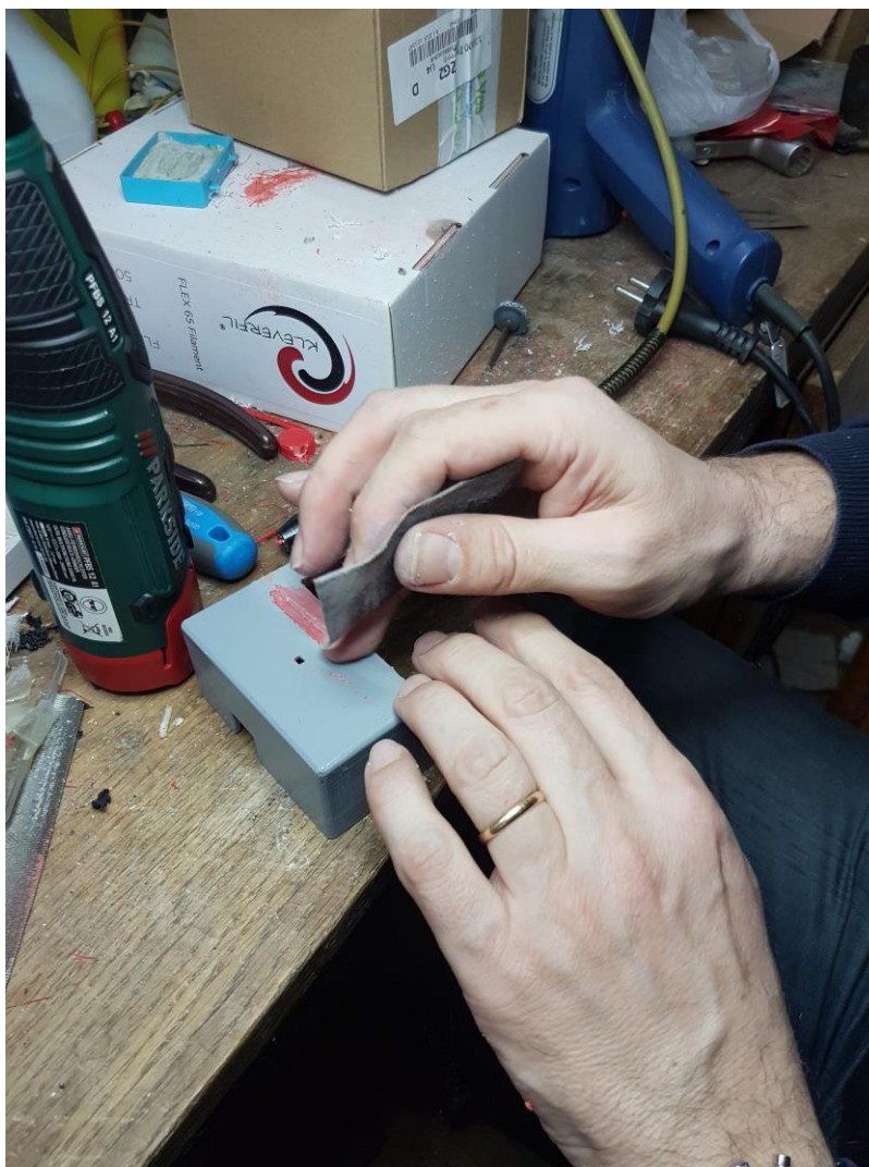
Slika 28. Prikaz postupka brušenja kućišta QrBox-a
