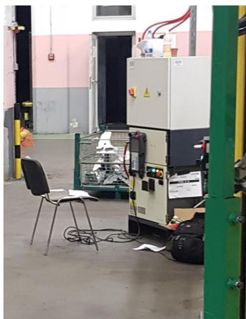
Slika 12. Upravljačka jedinica robota, R30iB Plus
