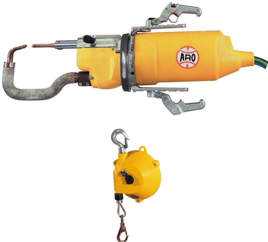
Slika 34. Ručna zavarna kliješta i balanser
