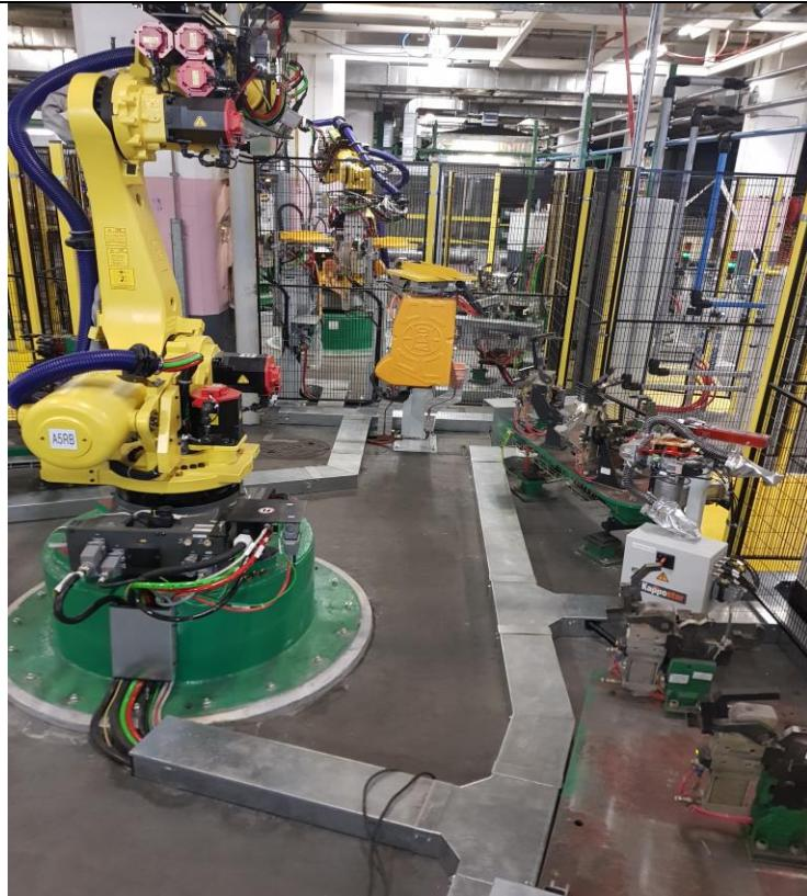
Slika 18. Zaštita i odvod kablova
