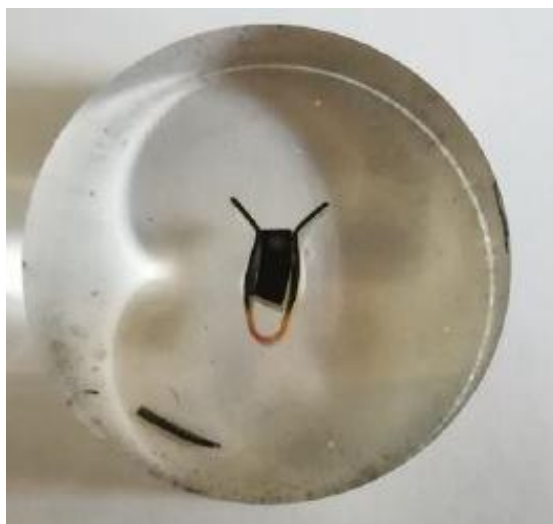
Sl. 60 Metallografski pripremljen ispitni uzorka za određivanje efektivne dubine nitriranja
