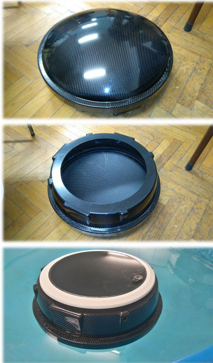
Slika 4.14 Lakiranje ljuske bezbojnim premazom, bušenje prodora za kablove te ljepljenje palubnog poklopca
