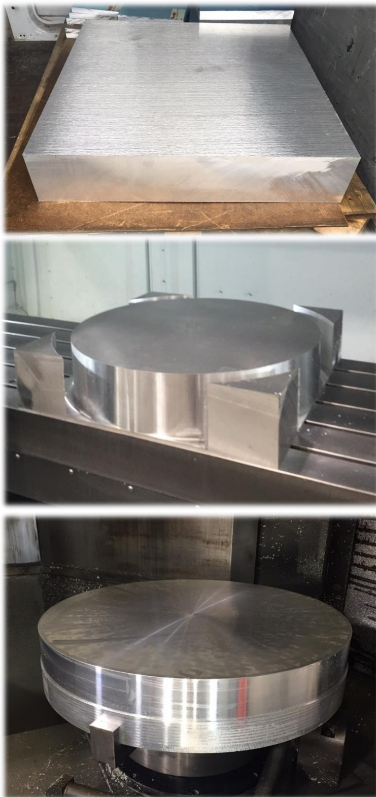
Slika 4.11 Dobivanje cilindra iz piljenog ingota
