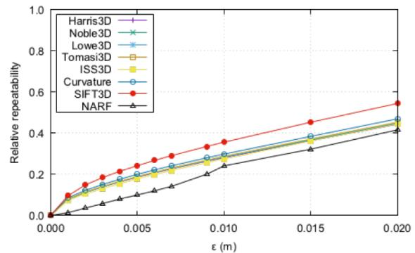
Slika 3.24. Ponovljivost za rotaciju od  $20^\circ$  - tipkovnica
