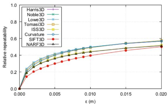
Slika 3.28. Ponovljivost za rotaciju od  $20^\circ$  - vrč
