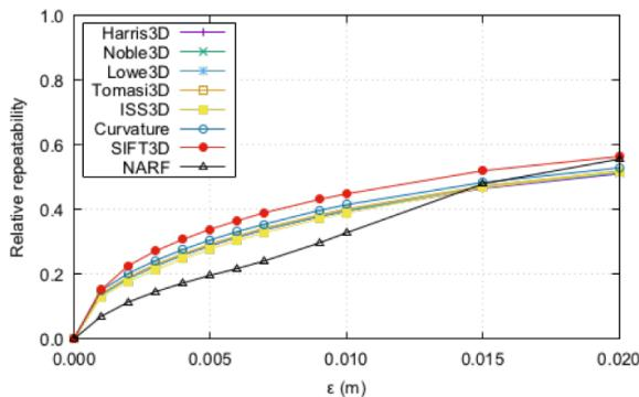
Slika 3.23. Ponovljivost za rotaciju od  $10^\circ$  - tipkovnica
