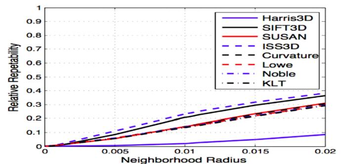
Slika 3.20. Ponovljivost za rotaciju od  $35^\circ$
