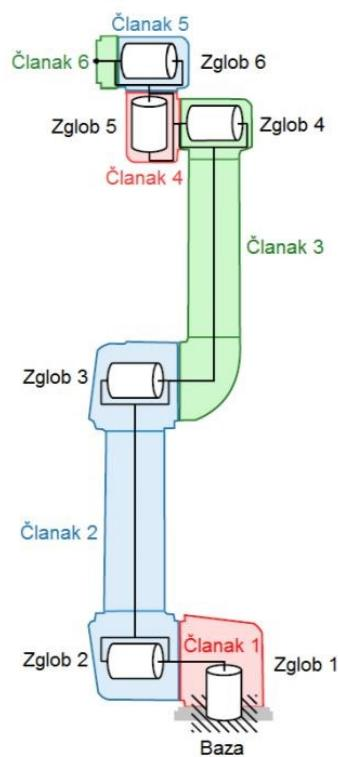
Slika 5.1. Zglobovi i segmenti UR5 robotske ruke [28]
