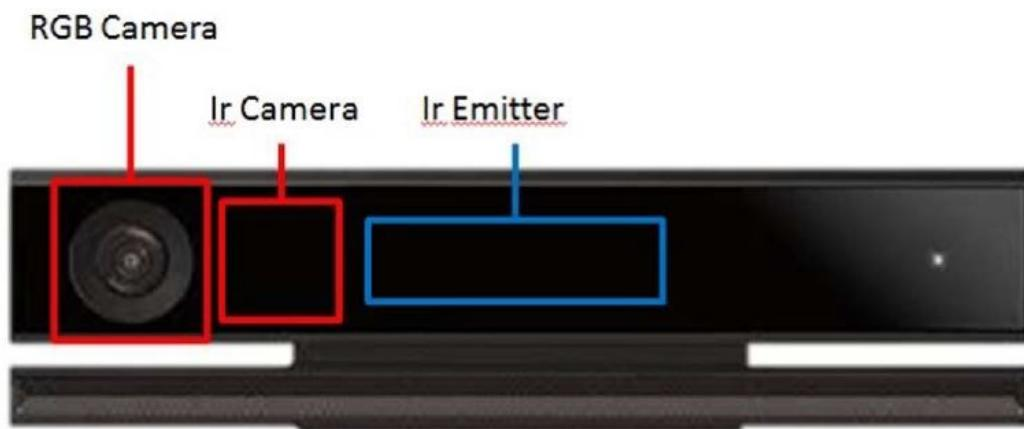
Slika 2.11. Kinect v2 – pozicija kamera i IR emitera
