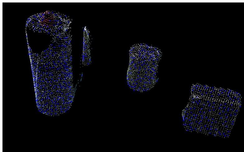
**Slika 4.9. ISS3D ključne točke**
