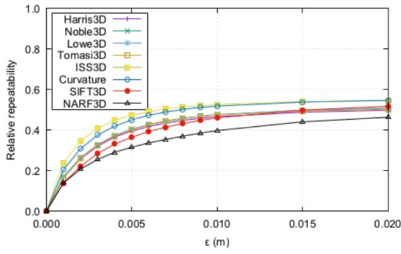
Slika 3.27. Ponovljivost za rotaciju od  $10^\circ$  - vrč
