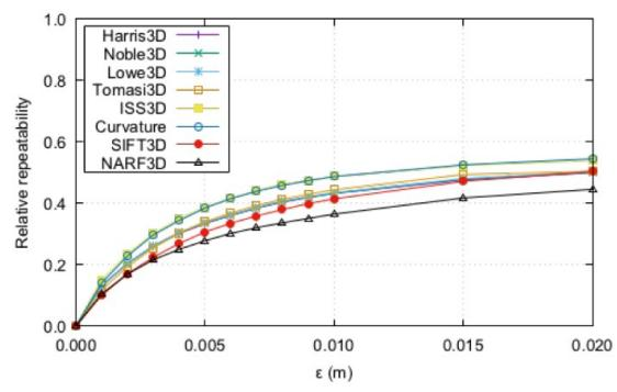
Slika 3.26. Ponovljivost za rotaciju od  $20^\circ$  - dječja kolica
