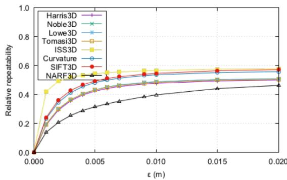
Slika 3.25. Ponovljivost za rotaciju od  $10^\circ$  - dječja kolica
