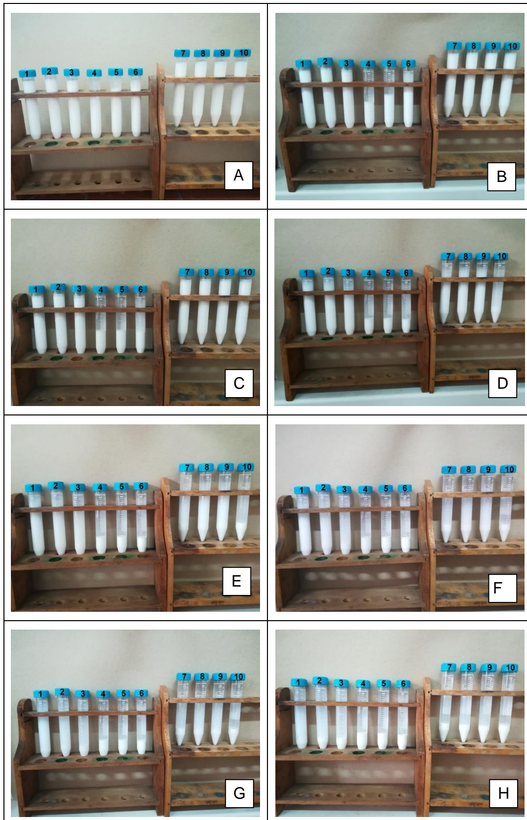
Slika 26. Graduirane epruvete u kojima je 20 %-tna Al_2O_3 vodena suspenzija stabilizirana s 0,2 % Dolapixa nakon (A) 15 minuta, (B) 1 sat, (C) 2 sata, (D) 24 sata, (E) 48 sati, (F) 72 sata, (G) 96 sati i (H) 168 sati sedimentacije
