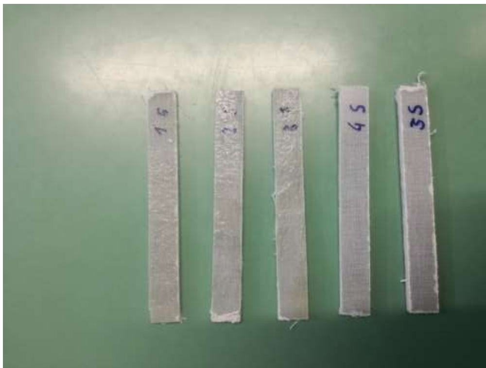
Slika 5.21. Epruvete spremne za savojno ispitivanje
