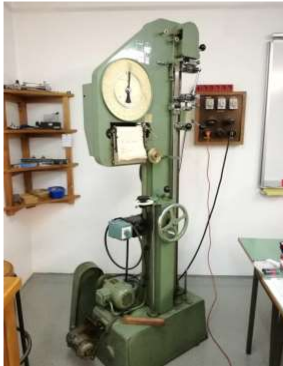
Slika 5.11. Kidalica za statično vlačno ispitivanje
