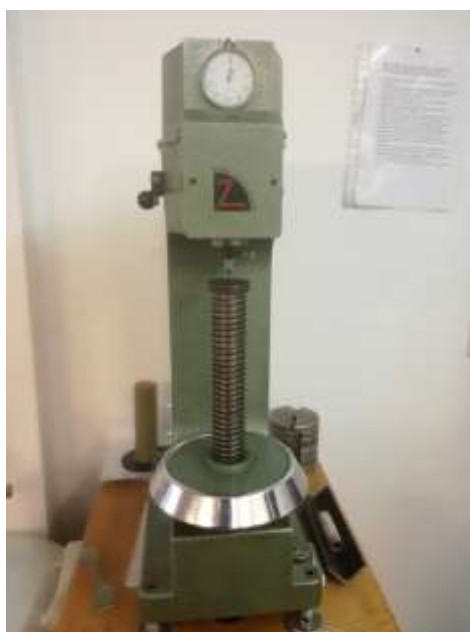
Slika 5.34. Tvrdomjer za ispitivanje tvrdoće
