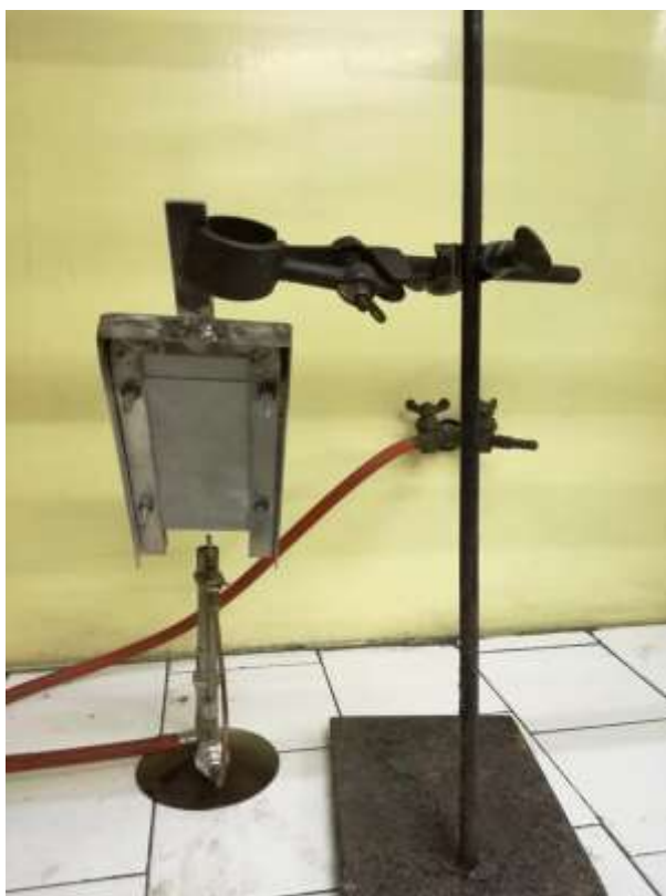
Slika 5.37. Epruveta spremna za ispitivanje samogasivosti
