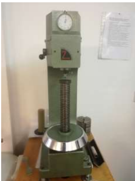
Slika 5.34. Tvrdomjer za ispitivanje tvrdoće
