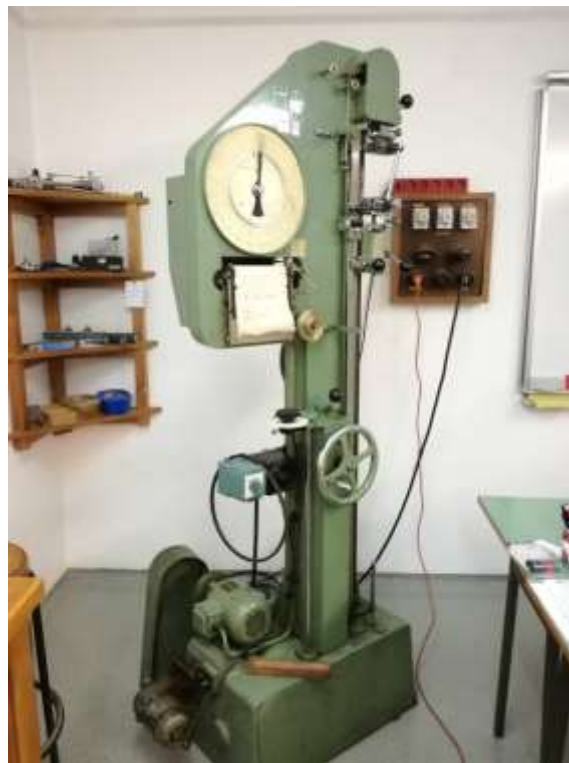
Slika 5.22. Kidalica za savojno ispitivanje
