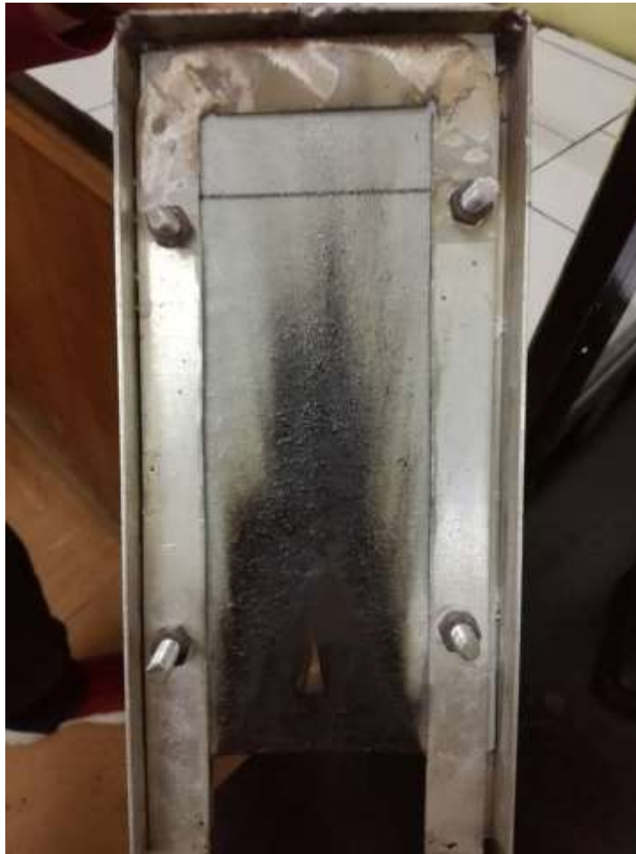
Slika 5.39. Epruveta nakon ispitivanja samogasivosti
