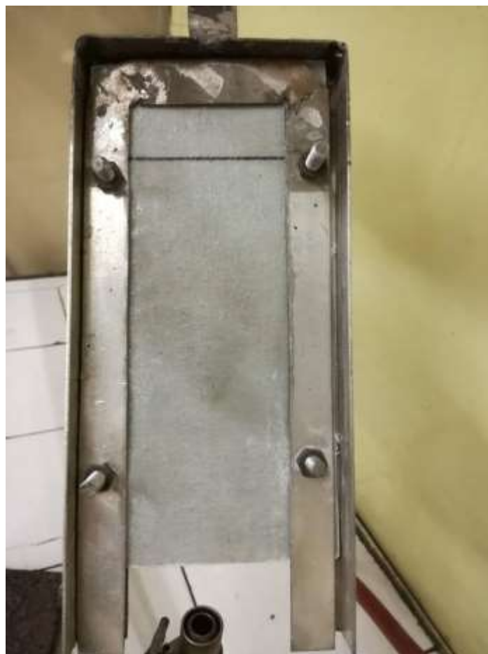
Slika 5.38. Epruveta prije ispitivanja samogasivosti
