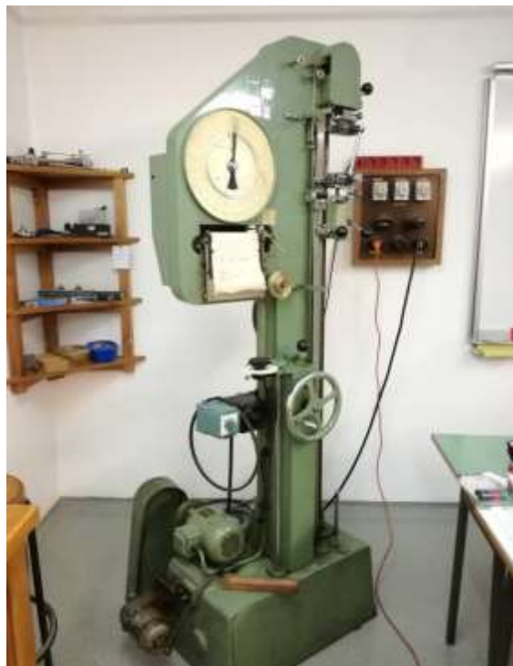
Slika 5.11. Kidalica za statično vlačno ispitivanje
