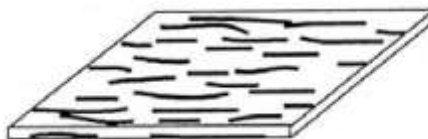
Slika 2.6. Primjer usmjerenog ojačanja kratim vlaknima [37]
