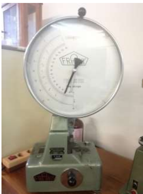
Slika 5.32. Charpyjev bat proizvođača Karl Frank
