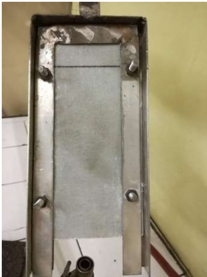
Slika 5.38. Epruveta prije ispitivanja samogasivosti
