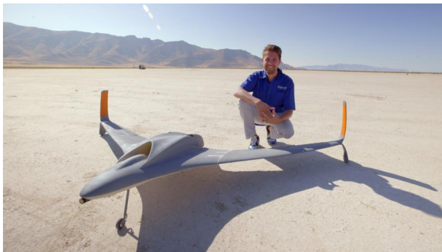
Slika 5 Primjer bespilotne letjelice tvrtke Aurora Flight Sciences napravljene FDM metodom od Ultema [7]
