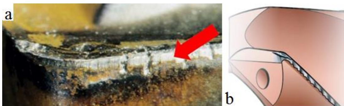
Slika 20. Toplinska napuknuća a) prema [25], b) prema [12]
