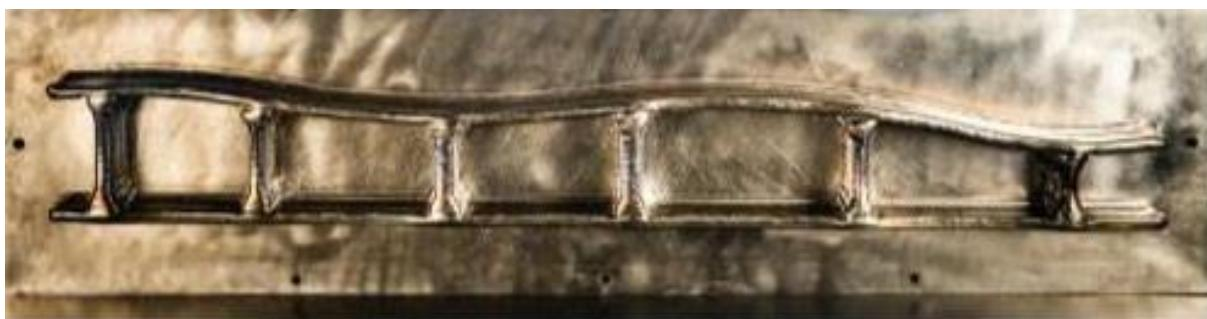
Slika 8. Dio strukture krila zrakoplova [8]
