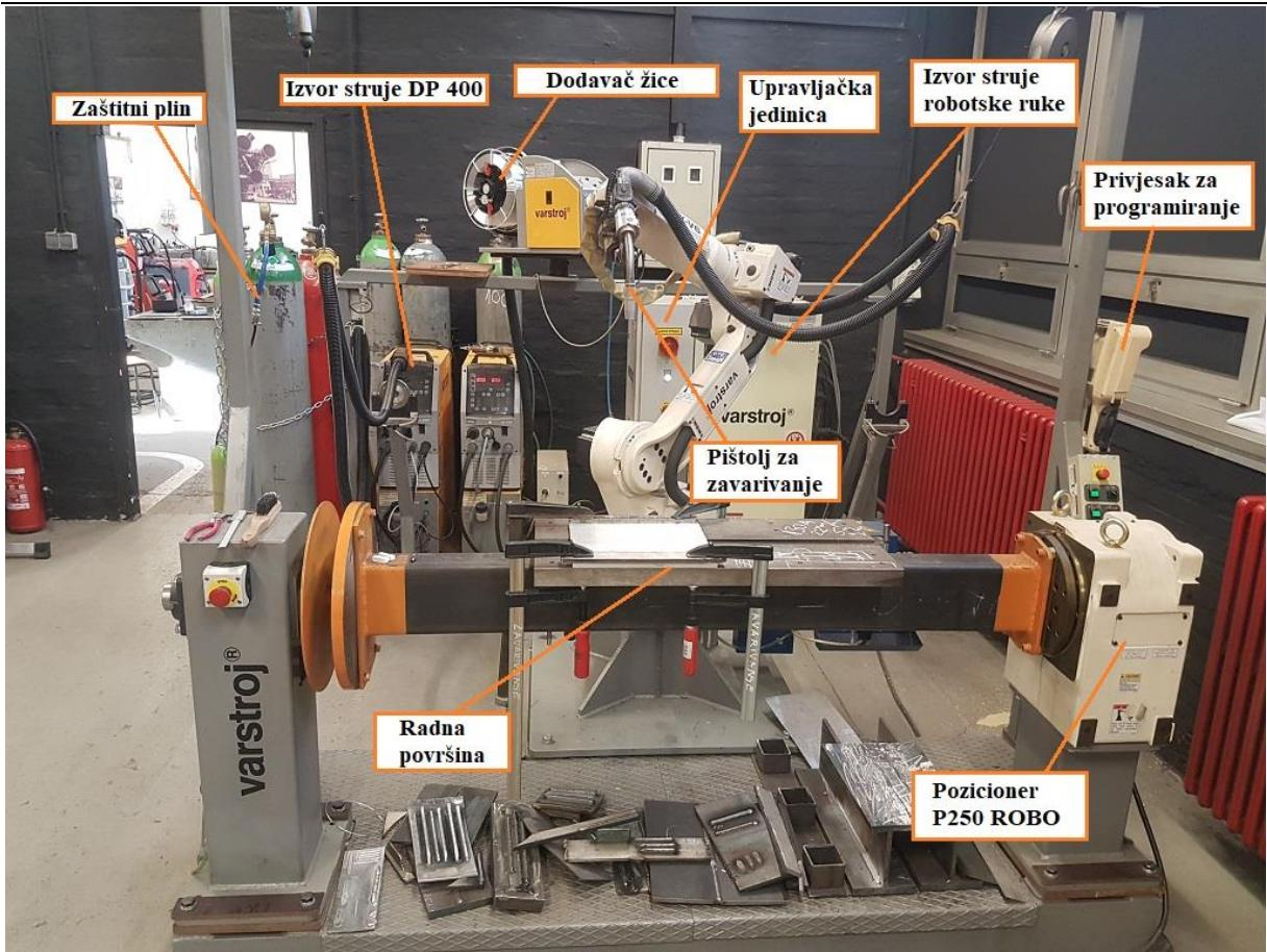
Slika 17. Robotska stanica Almega OTC AX V6
