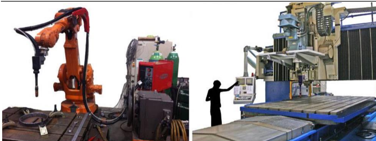
Slika 5. Strojevi za ostvarivanje gibanja pištolja [8]
