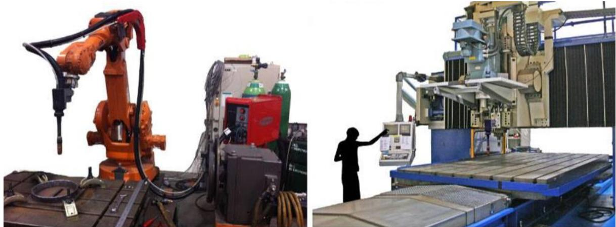
Slika 5. Strojevi za ostvarivanje gibanja pištolja [8]
