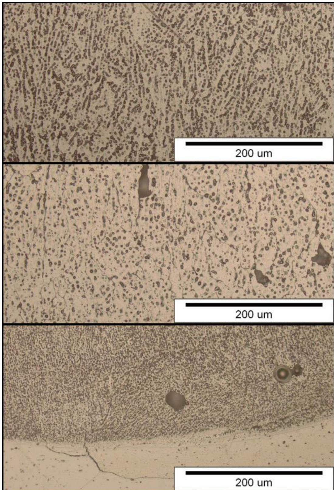
Slika 27. Mikrostruktura uzorka 2 redom vrh, sredina i ZUT
