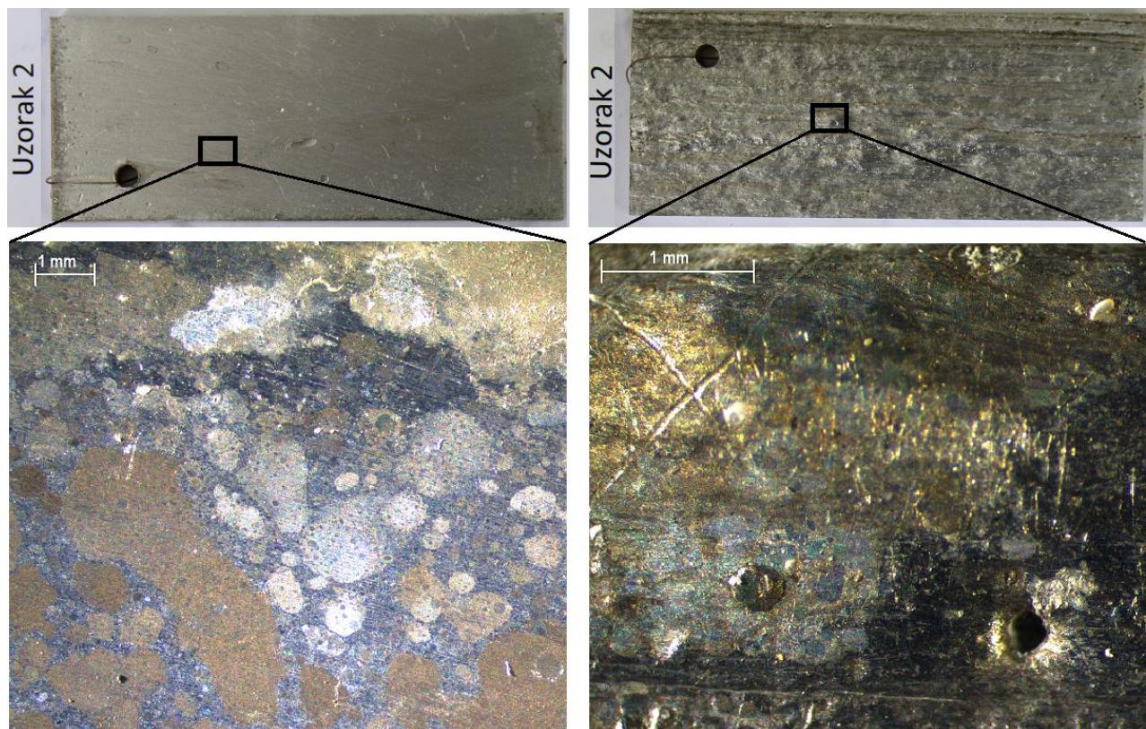
Slika 45. Prikaz nakon 36 sati izlaganja uzoraka 2 slanoj komori
