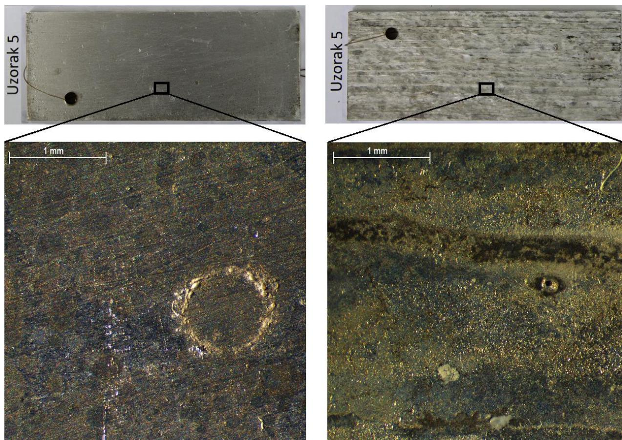
Slika 47. Prikaz nakon 36 sati izlaganja uzoraka 5 slanoj komori
