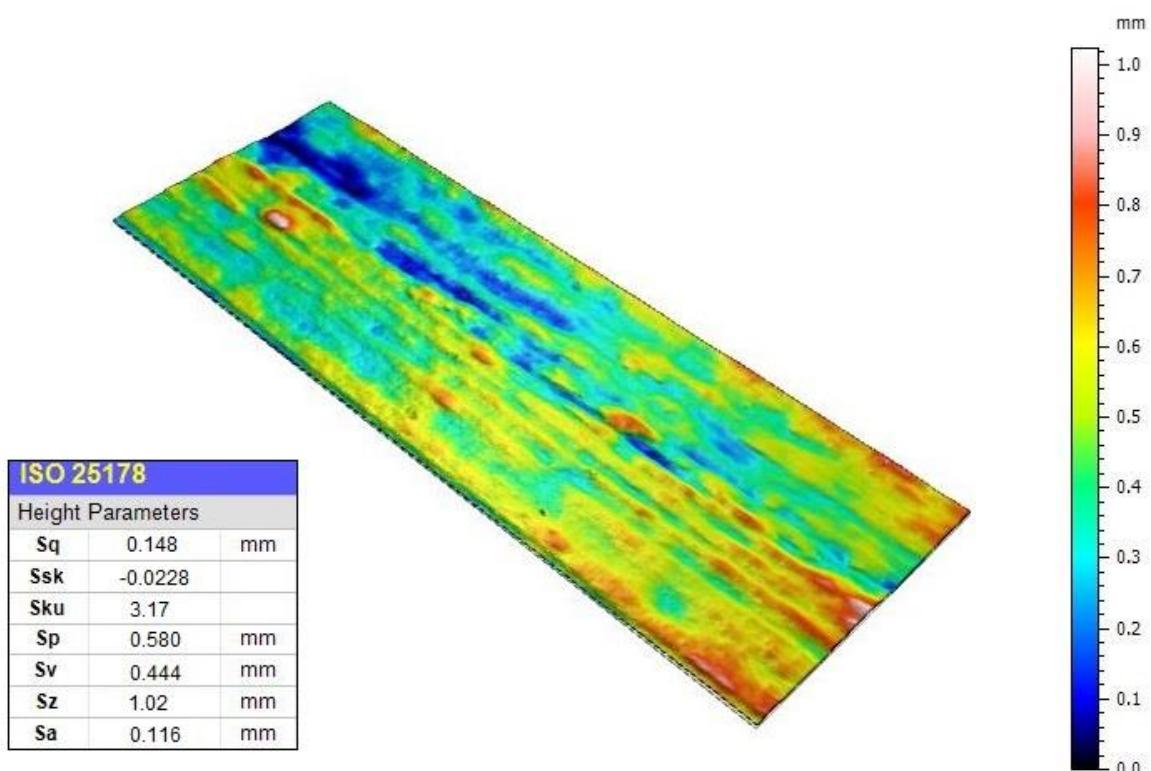
**Slika 33. Parametri teksture površine za uzorak 2**
