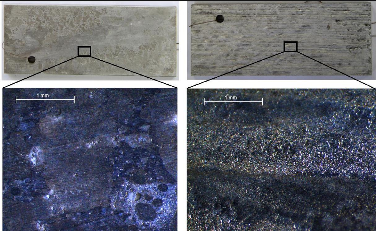
Slika 51. Prikaz nakon 240 sati izlaganja uzorka 5 slanoj komori
