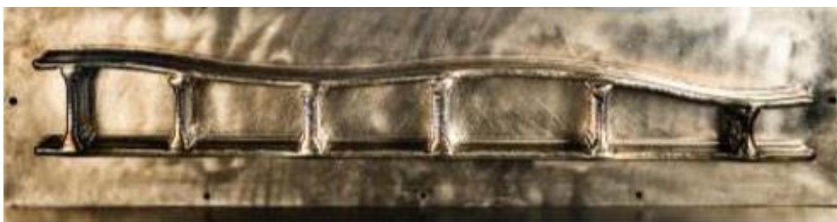
Slika 8. Dio strukture krila zrakoplova [8]
