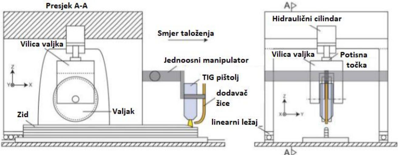
Slika 6. Shema WAAM sustava taloženja i valjanja [8]
