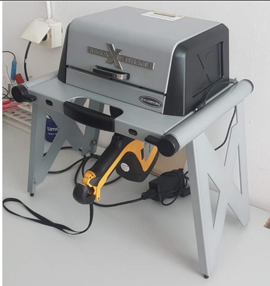
**Slika 41. Olympus XRF uređaj****Tablica 16. Udio legirnih elemenata na uzorcima**
