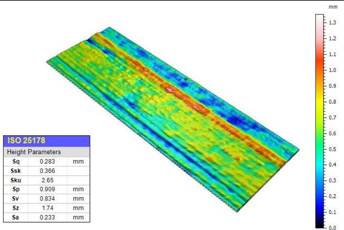
Slika 34. Parametri tekture površine za uzorak 4
