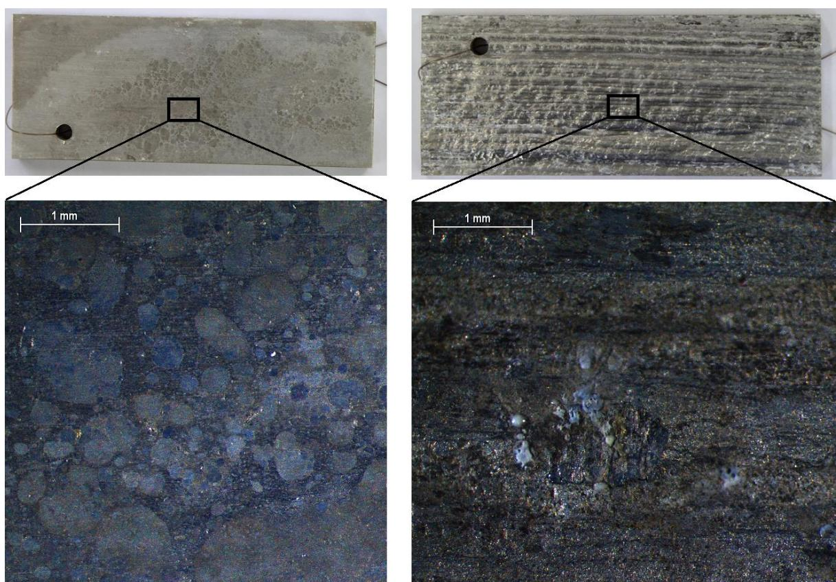
Slika 50. Prikaz nakon 240 sati izlaganja uzorka 4 slanoj komori
