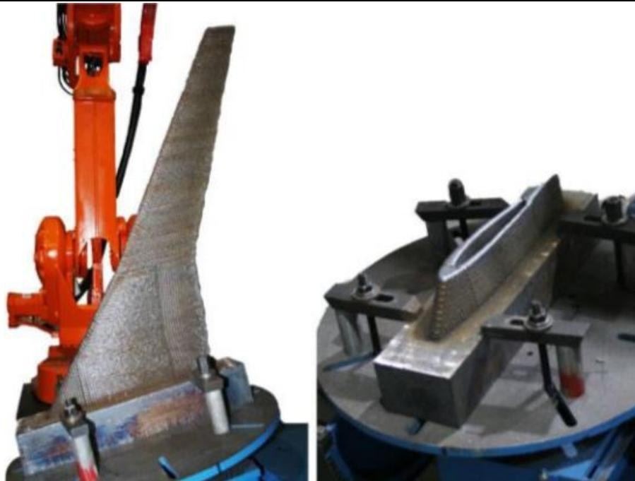
Slika 11. Testno krilo izrađeno WAAM tehnologijom [8]
