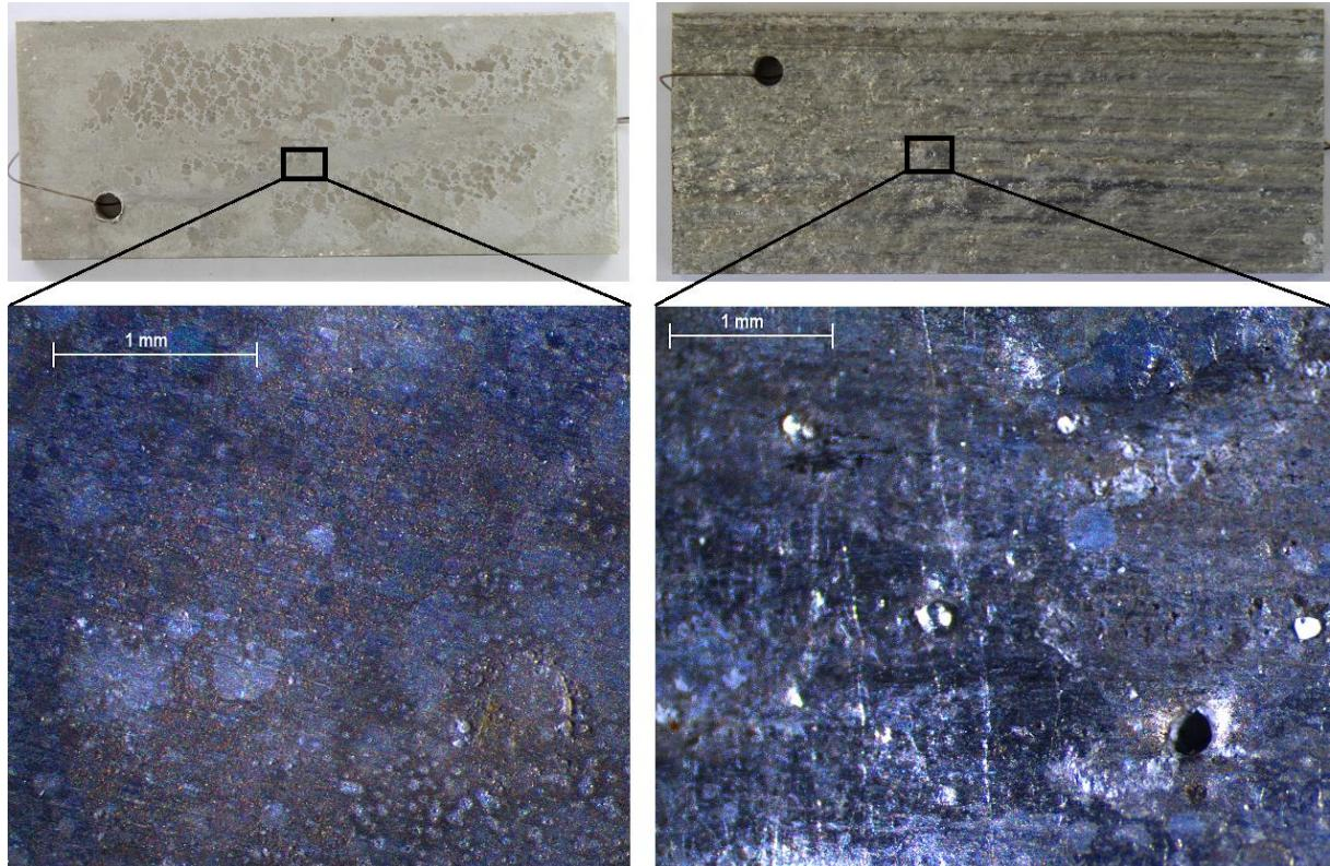
Slika 49. Prikaz nakon 240 sati izlaganja uzorka 2 slanoj komori
