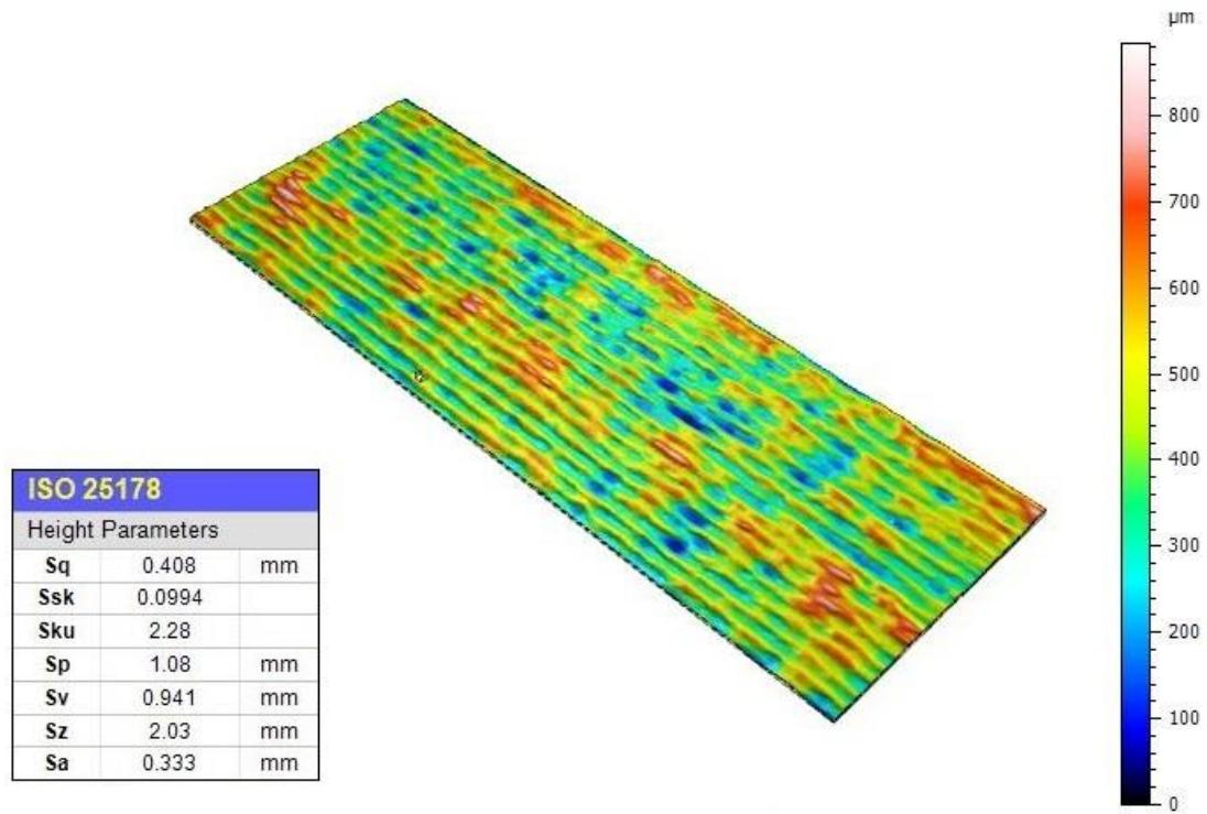
Slika 36. Parametri teksture površine za uzorak 6
