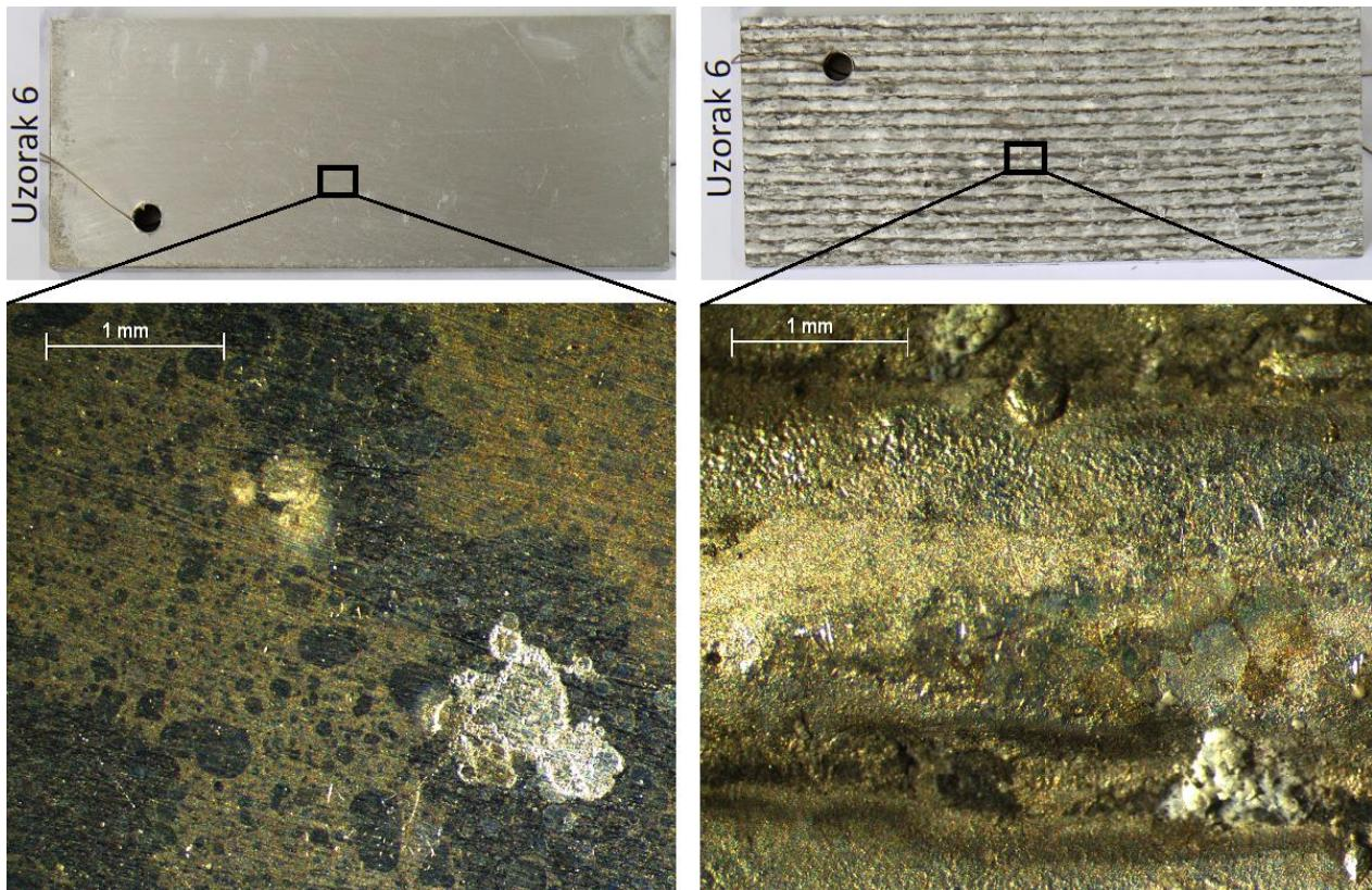
**Slika 48. Prikaz nakon 36 sati izlaganja uzoraka 6 slanoj komori**
