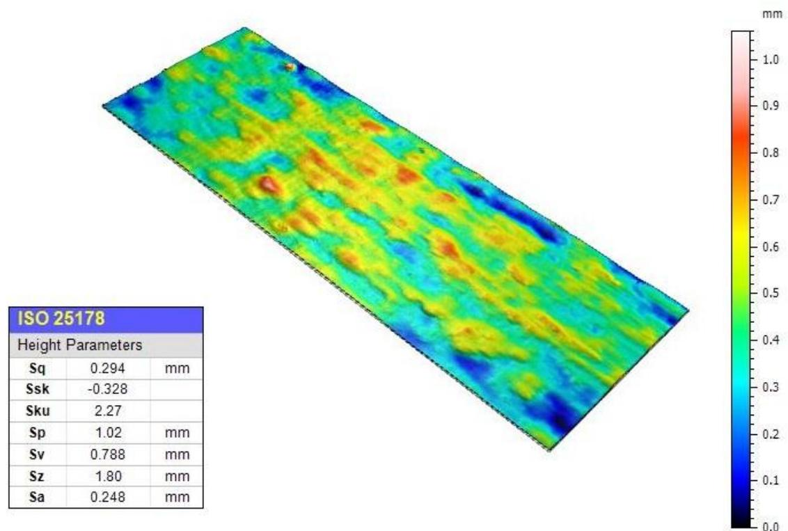
Slika 35. Parametri tekture površine za uzorak 5
