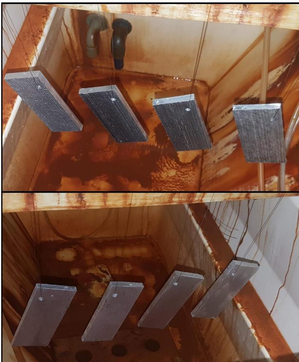
Slika 44. Uzorci postavljeni u slanu komoru
