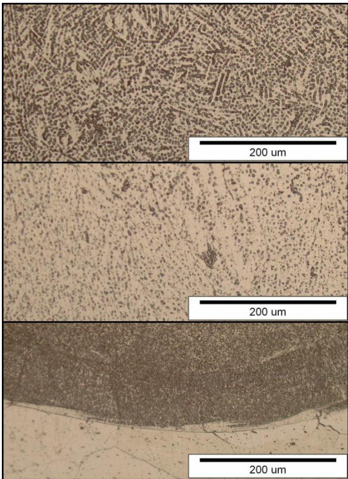
Slika 28. Mikrostruktura uzorka 4 redom vrh, sredina i ZUT
