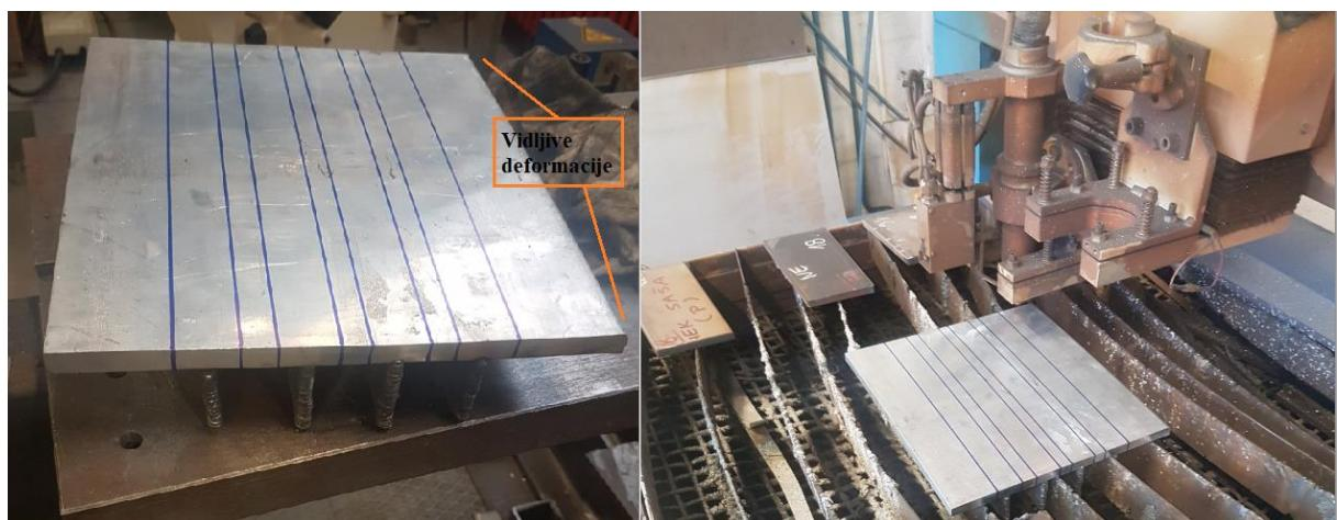
Slika 22. Deformacija osnovne ploče i prikaz plazma rezačice
