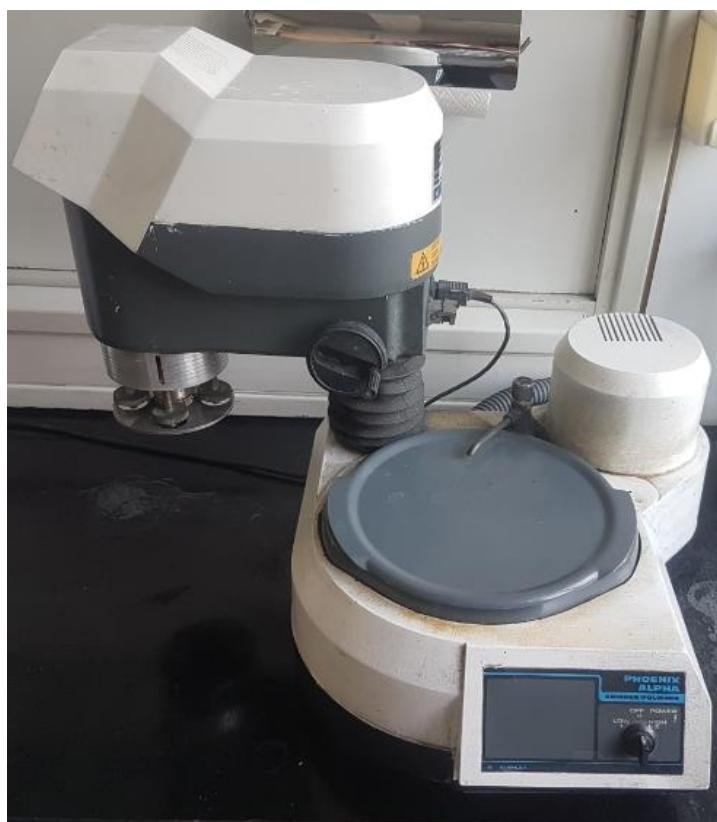
Slika 23. Uređaj za fino brušenje
