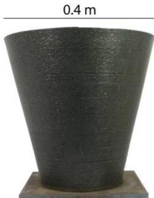
Slika 12. Čelična konusna posuda izrađena WAAM postupkom [8]
