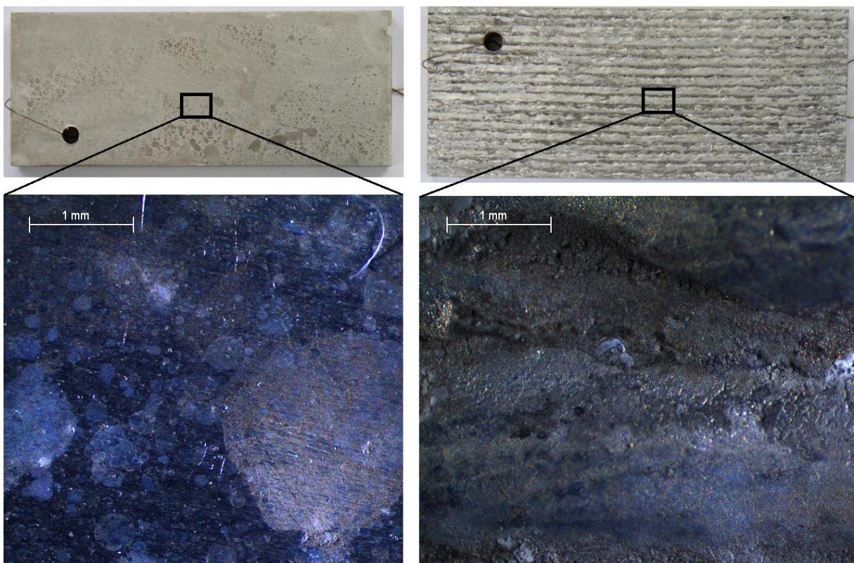
Slika 52. Prikaz nakon 240 sati izlaganja uzorka 6 slanoj komori
