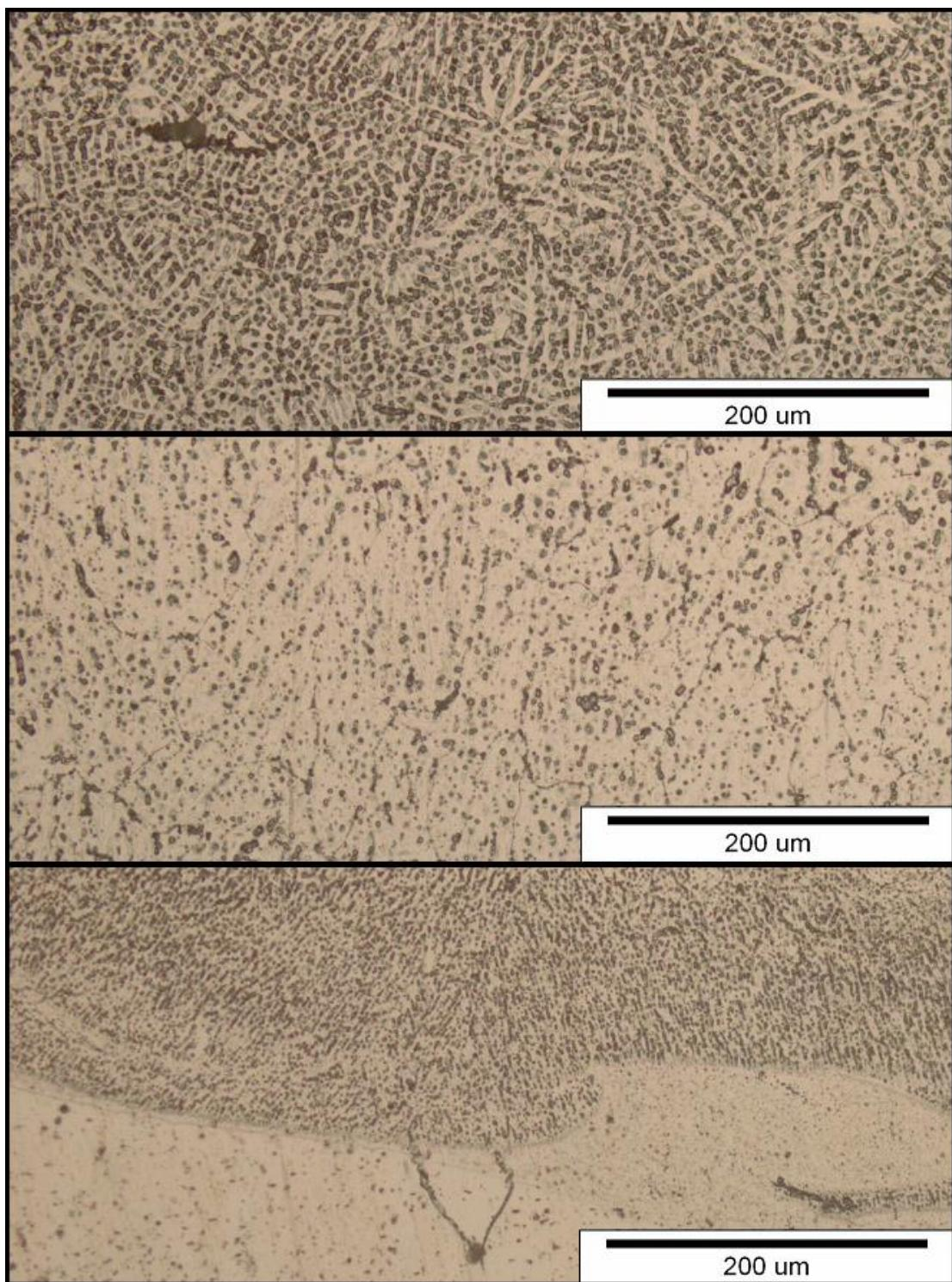
Slika 29. Mikrostruktura uzorka 5 redom vrh, sredina i ZUT
