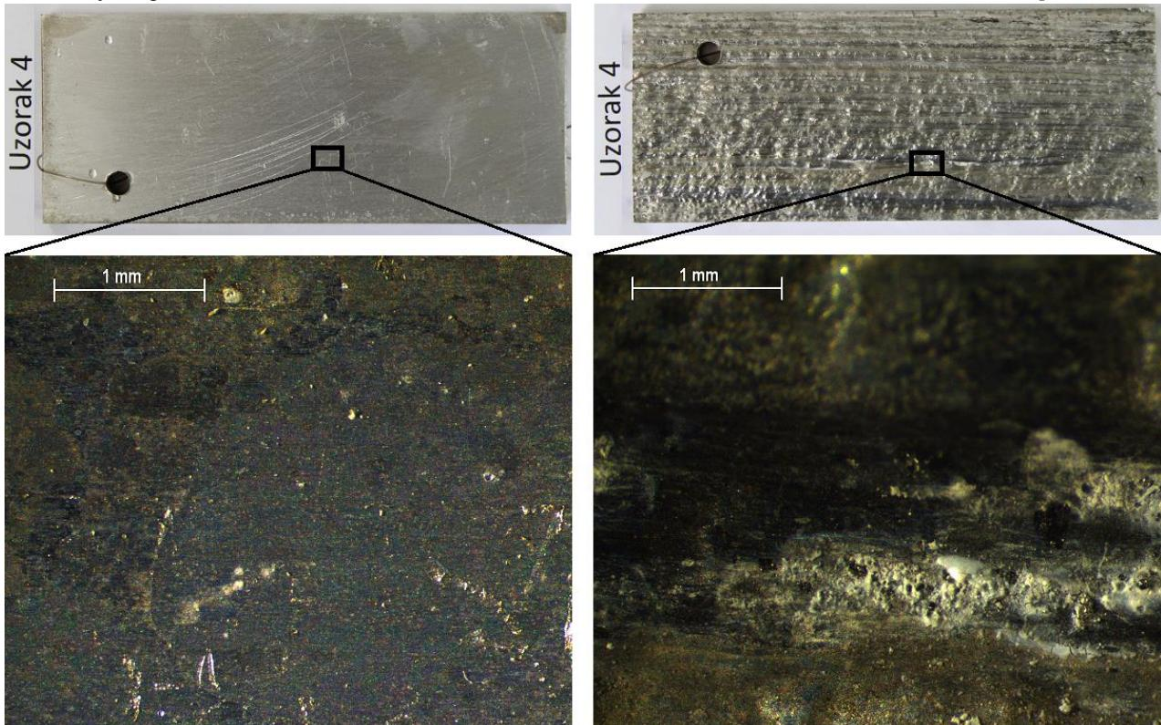
Slika 46. Prikaz nakon 36 sati izlaganja uzoraka 4 slanoj komori
