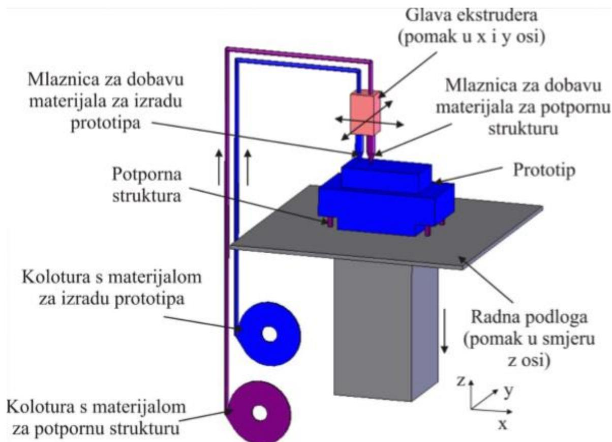
Slika 2. Shema aditivnog postupka taložnog očvršćivanja [5]
