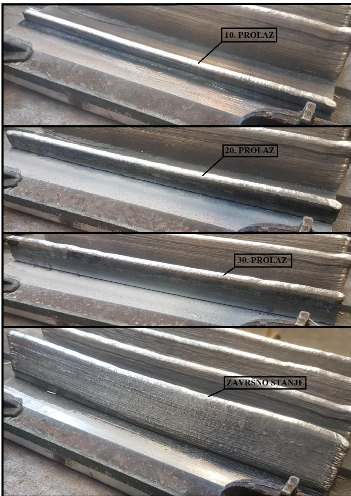
Slika 19. Prikaz postupnog nastajanja jednog od uzorka
