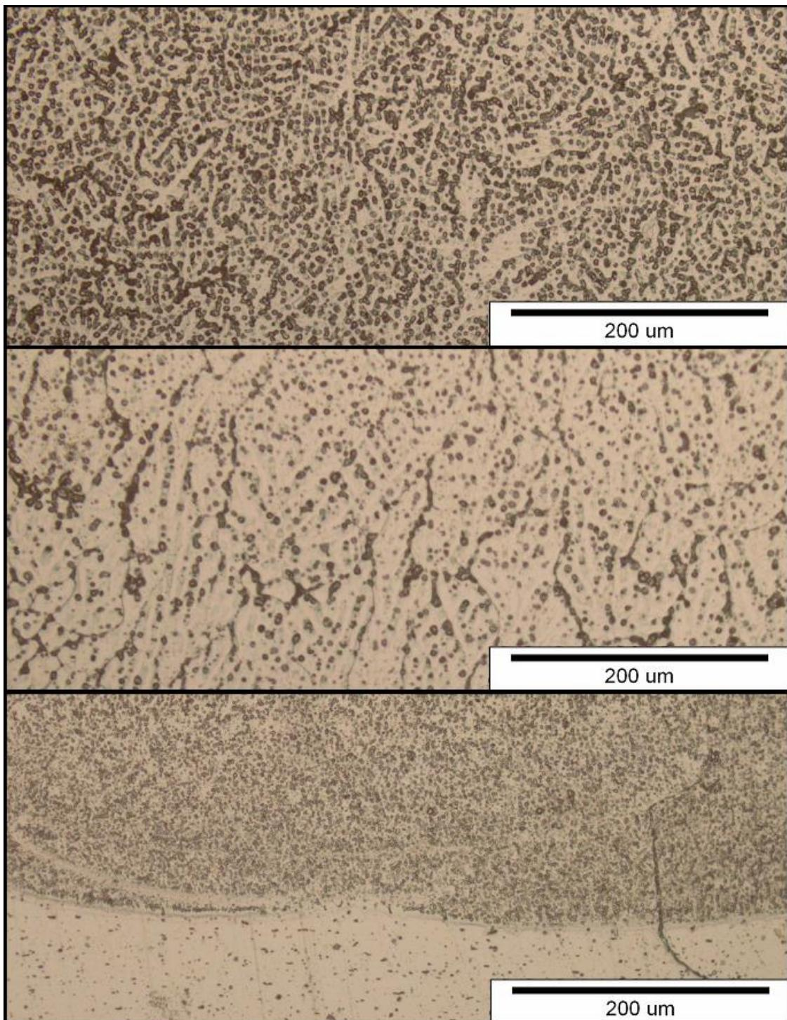
Slika 30. Mikrostruktura uzorka 6 redom vrh, sredina i ZUT
