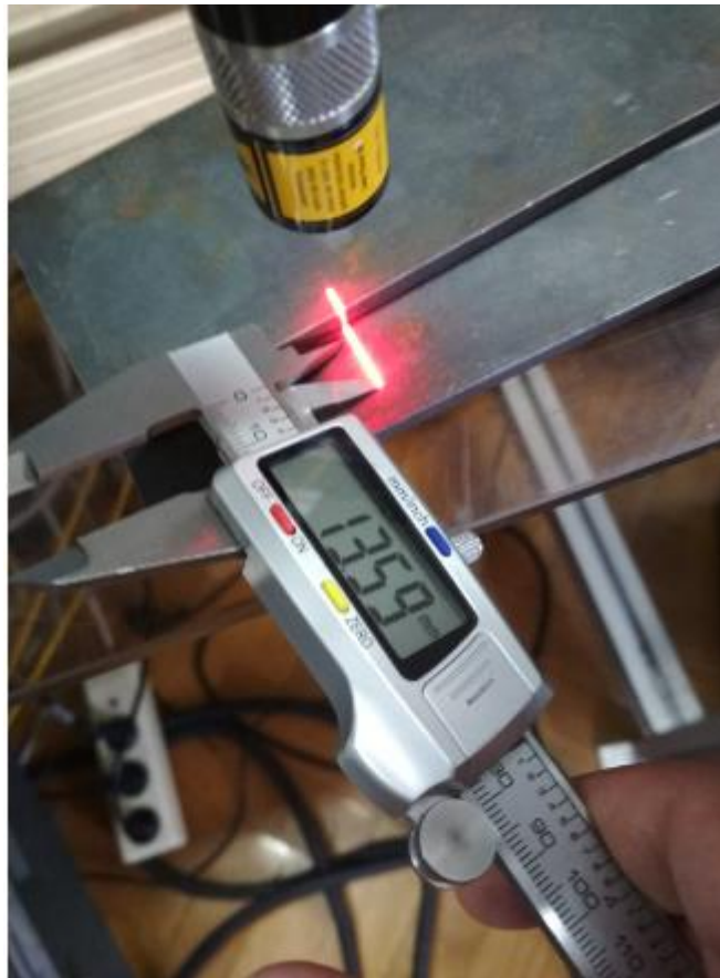
Slika 37: Duljina donje (dulje) laserske zrake
