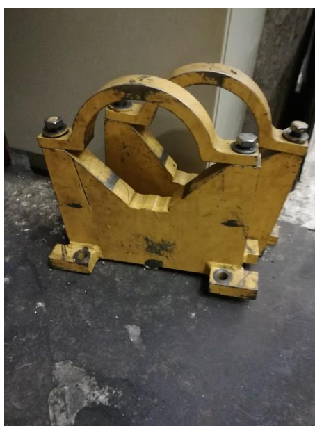
Slika 23. Stezna naprava za cijevi i šipke
