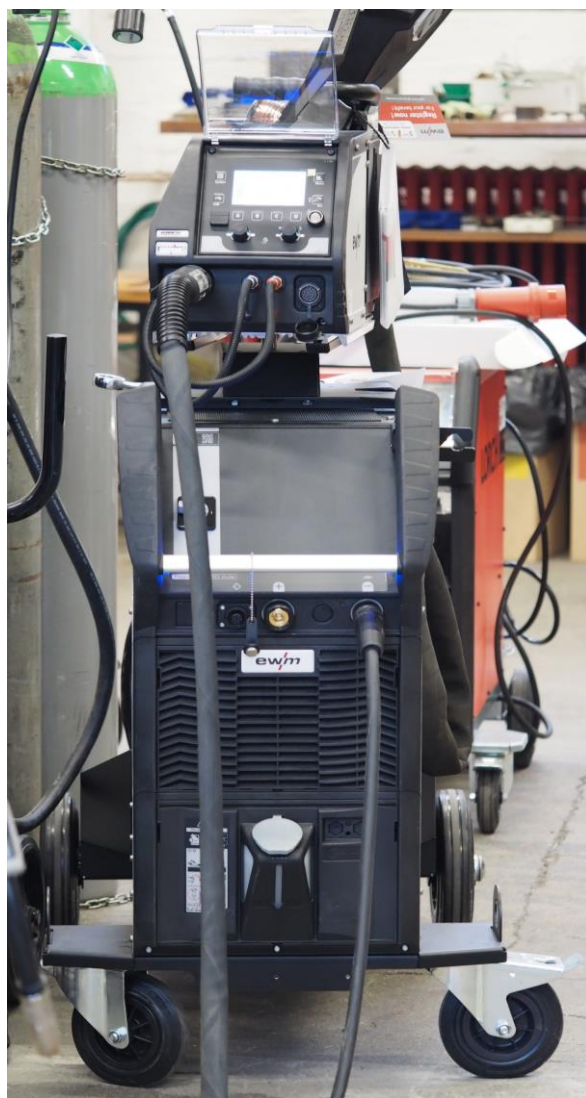
Slika 47. Izvor struje za zavarivanje Titan XQ 350 puls
