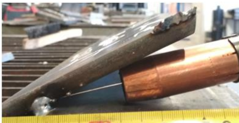
Slika 71. Položaj pištolja u žlijebu s kutom od 35^\circ
