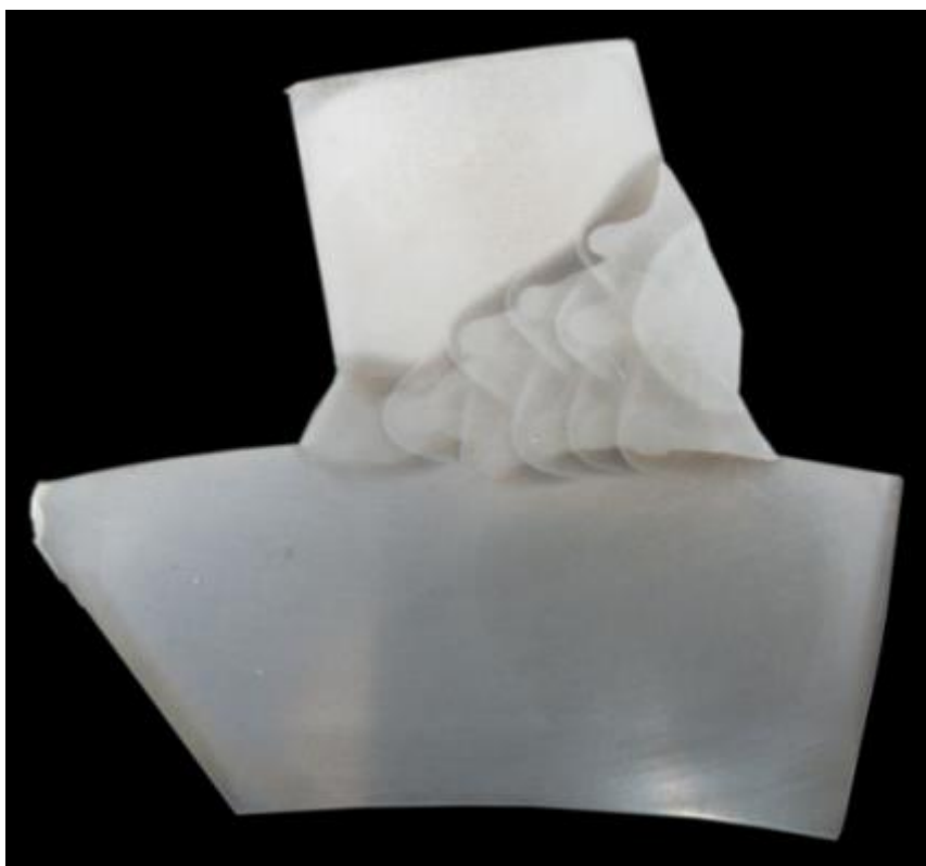
Slika 39. Zavareni spoj čelika S355 debljine 30 mm izveden forceArc postupkom [53]
