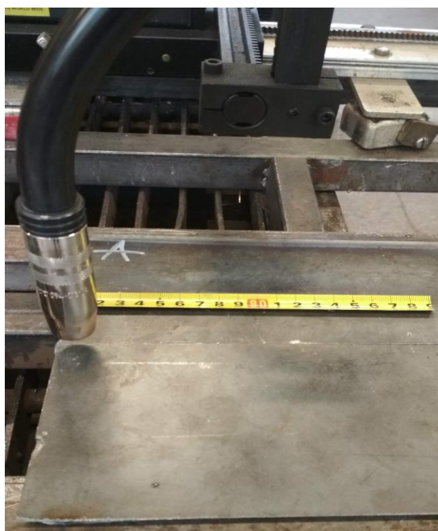
Slika 67. Prikaz položaja pištolja tijekom zavarivanja sučeljenog spoja
