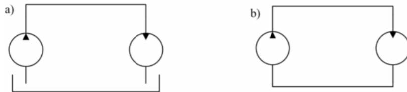
**Slika 4. Otvoreni (a) i zatvoreni (b) hidraulički krugovi**
