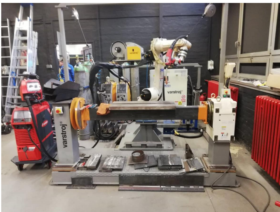
Slika 21 Robotska stanica Almega OTC AX V6
