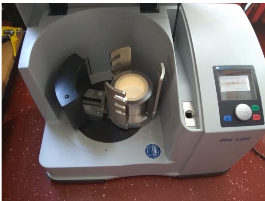
Slika 18. Planetarni kuglični mlin Retsch PM 100
