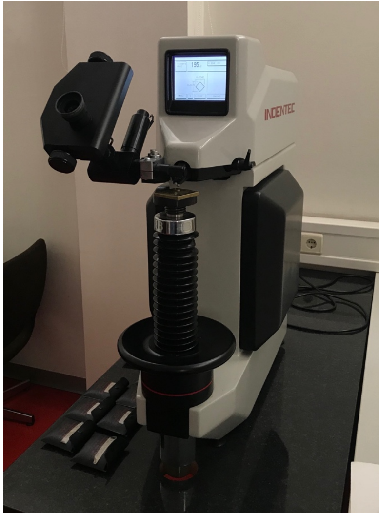
Slika 10. Ispitni tvrdomjer proizvođača Indentec
