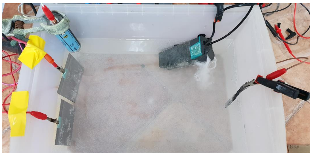
Slika 31. Detaljniji prikaz provedbe ispitivanja s katodnom zaštitom uzoraka
