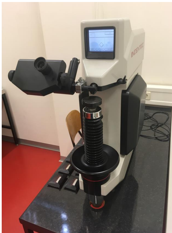
Slika 25. Uredaj za mjerenje tvrdoće
