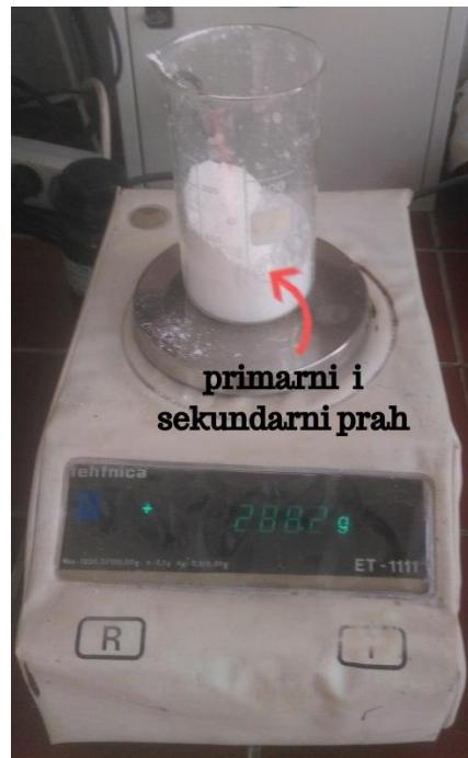
Slika 21. Vaganje primarnog i sekundarnog praha
