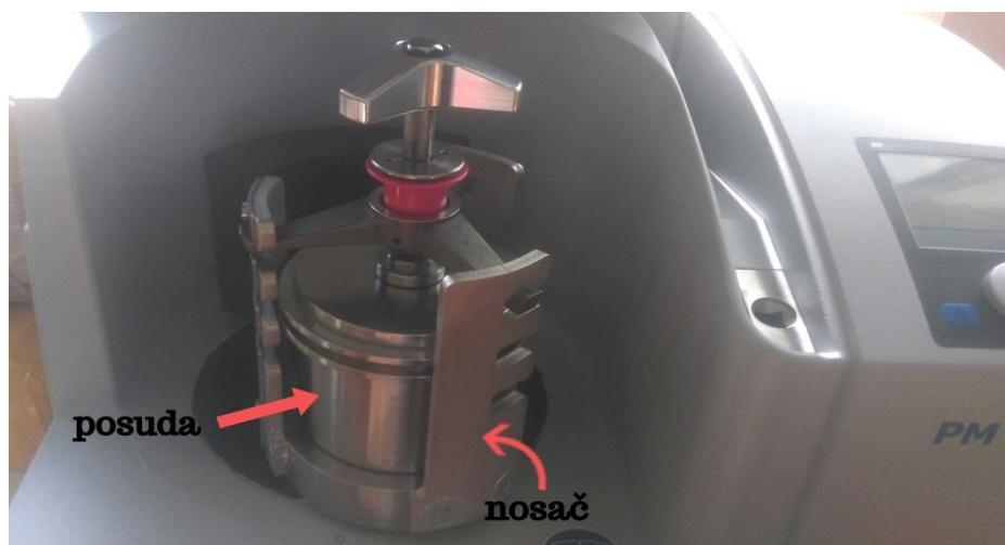
Slika 23. Mljevenje u kugličnom mlinu
