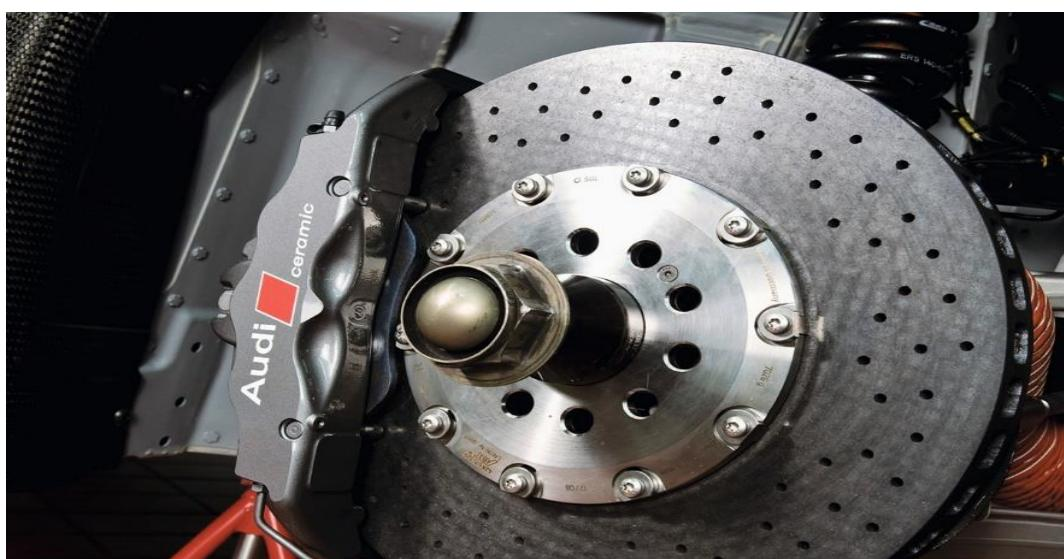
Slika 2. Keramičke disk-kočnice [3]
