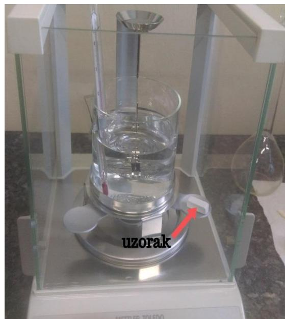
Slika 35. Mjerenje mase uzorka na zraku
