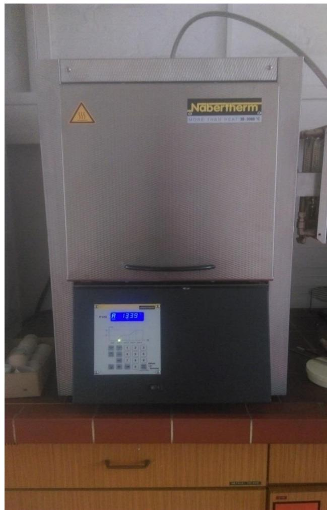
Slika 31. Električna peć za sinteriranje
