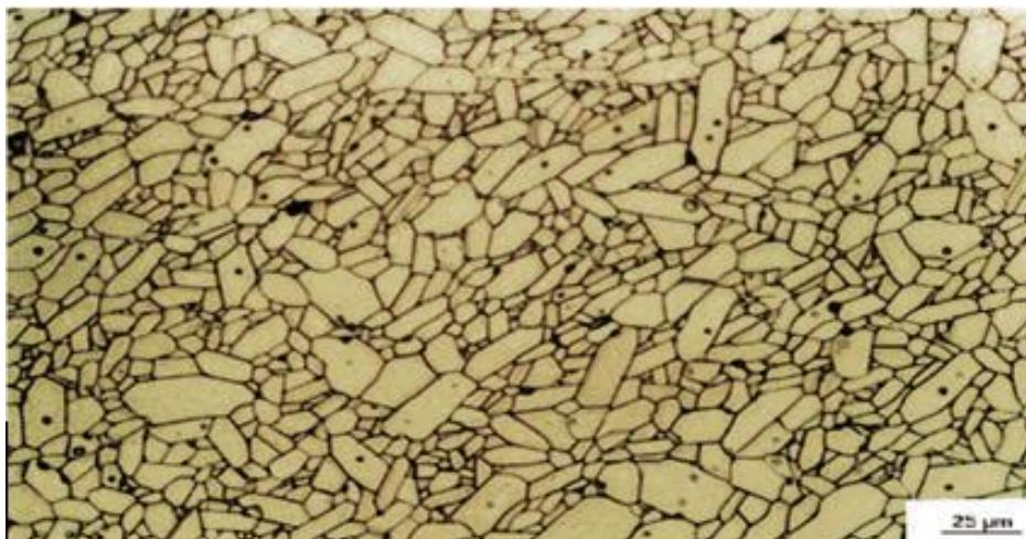
Slika 17. Mikrostruktura sinterirane aluminijeve oksidne keramike [15]
