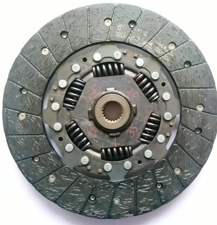
Slika 63. Tarna ploča #35 nakon sušenja u električnoj pećnici
