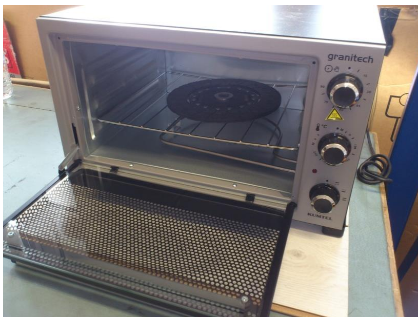
Slika 50. Sušenje tarne ploče u električnoj pećnici
