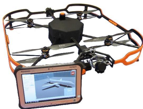
Slika 1. Dron za pregled zrakoplova tvrtke Donecle [1]
