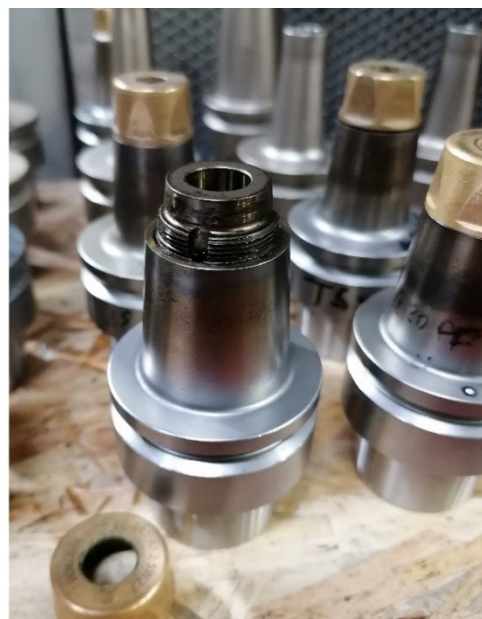
Slika 56. Coolcap prihvatili namijenjeni za hlađenje kroz glavno vreteno
