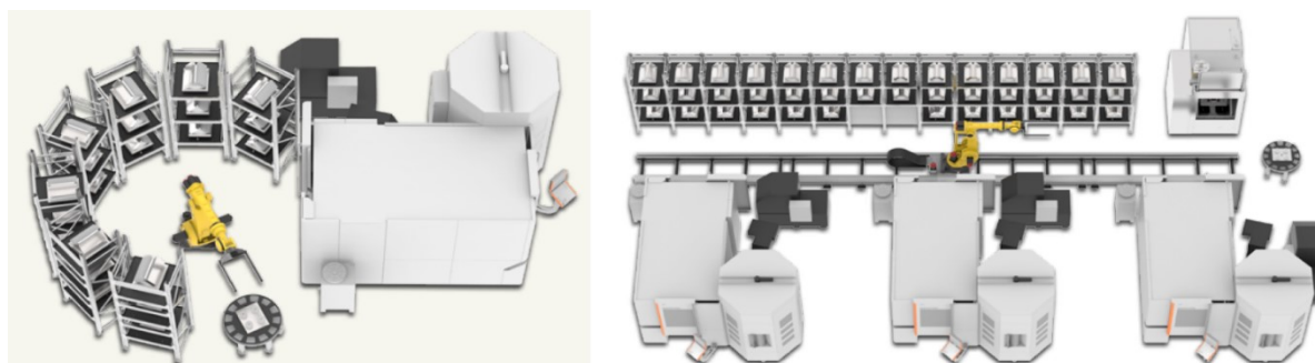
Slika 19. Ovalni (lijevo) i linijski (desno) magazin obradaka s manipulatorom [12]
