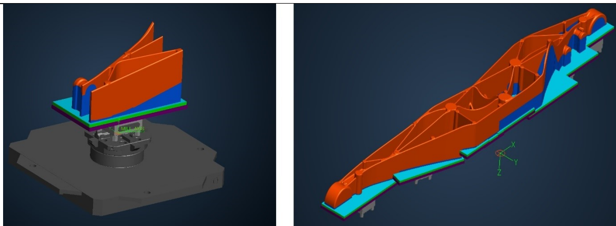
Slika 70. Prikaz elektrode iz TEBIS-a : 1 segment (lijevo), sklop ( desno)
