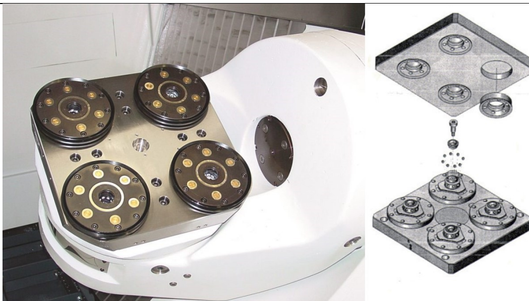
Slika 9. Stezni sustav s definiranom nul-točkom [11],[12]
