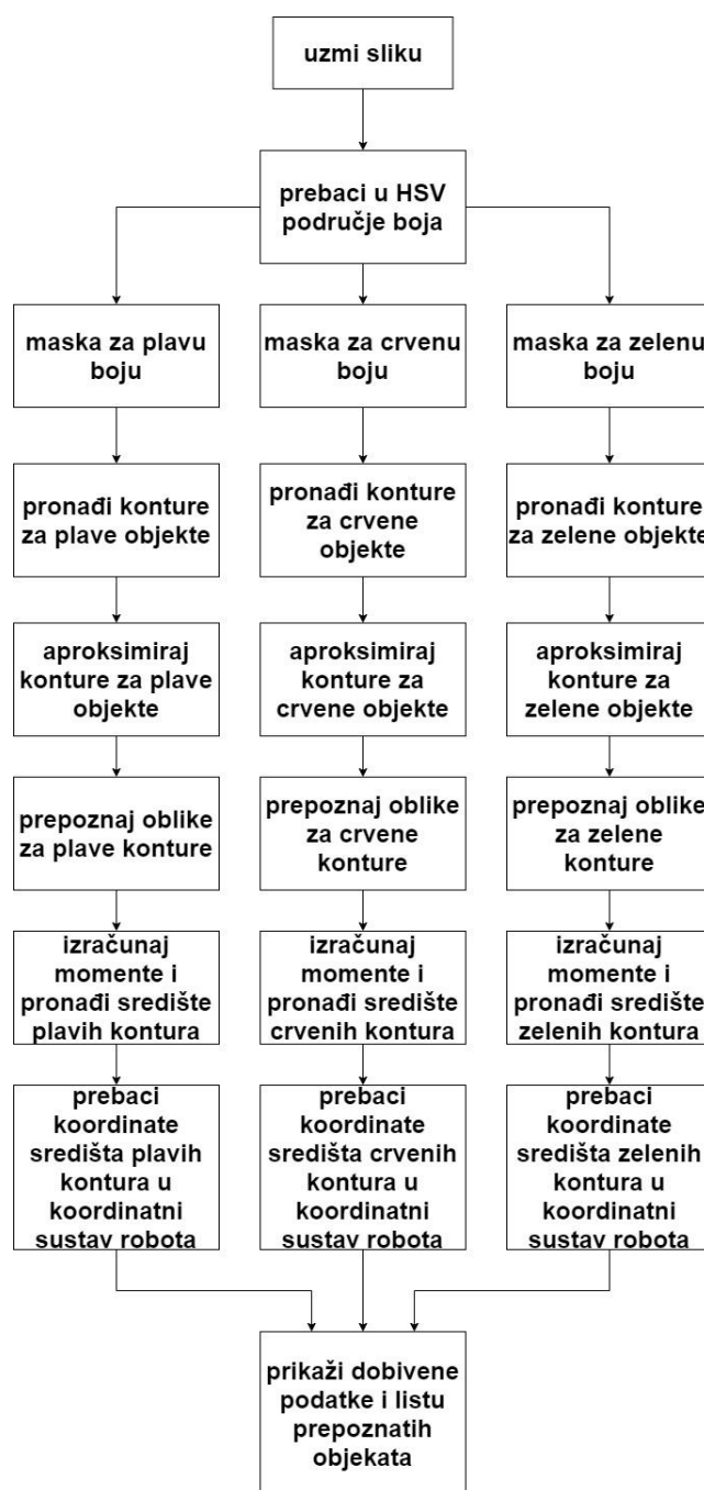
Slika 140. Proces prepoznavanja boje i oblika objekta
