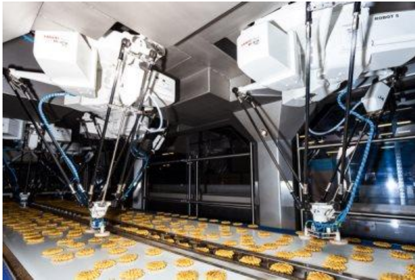
Slika 3. Delta robot, operacija izuzmi-odloži [4]
