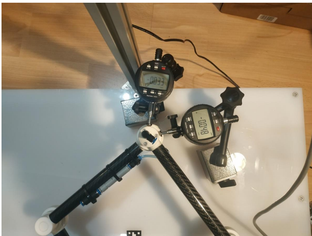
Slika 151. Mjerenje ponovljivosti, pozicija 1, robot primaknut
