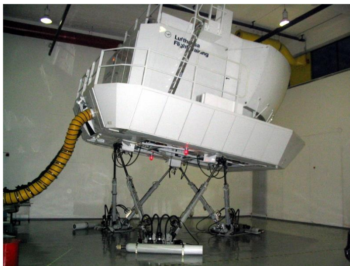
Slika 2. Heksapodni robot za simulaciju leta [3]
