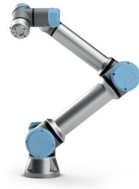
Slika 17. UR5 kolaborativni robot
