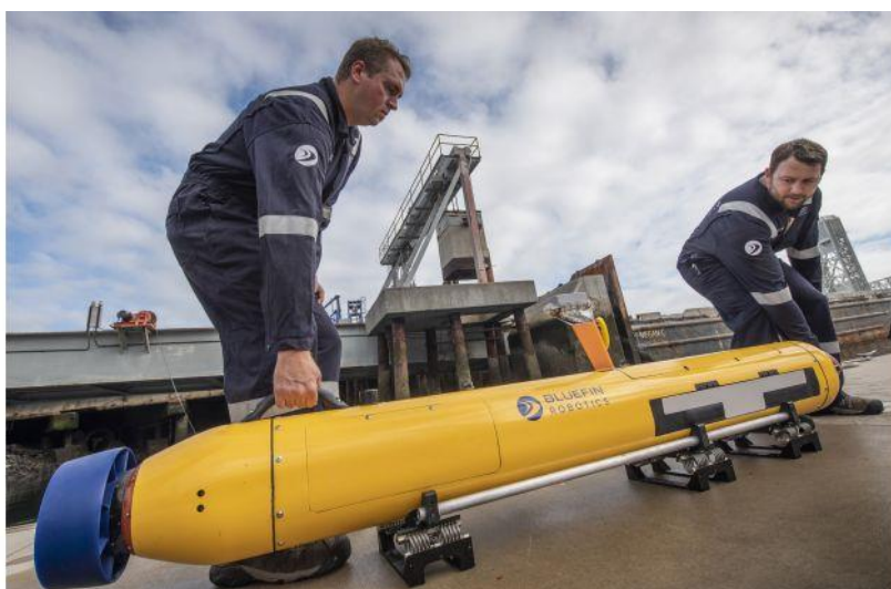
Slika 10. Podvodno autonomno vozilo u obliku podmornice tvrtke Bluefin Sandshark [9]
