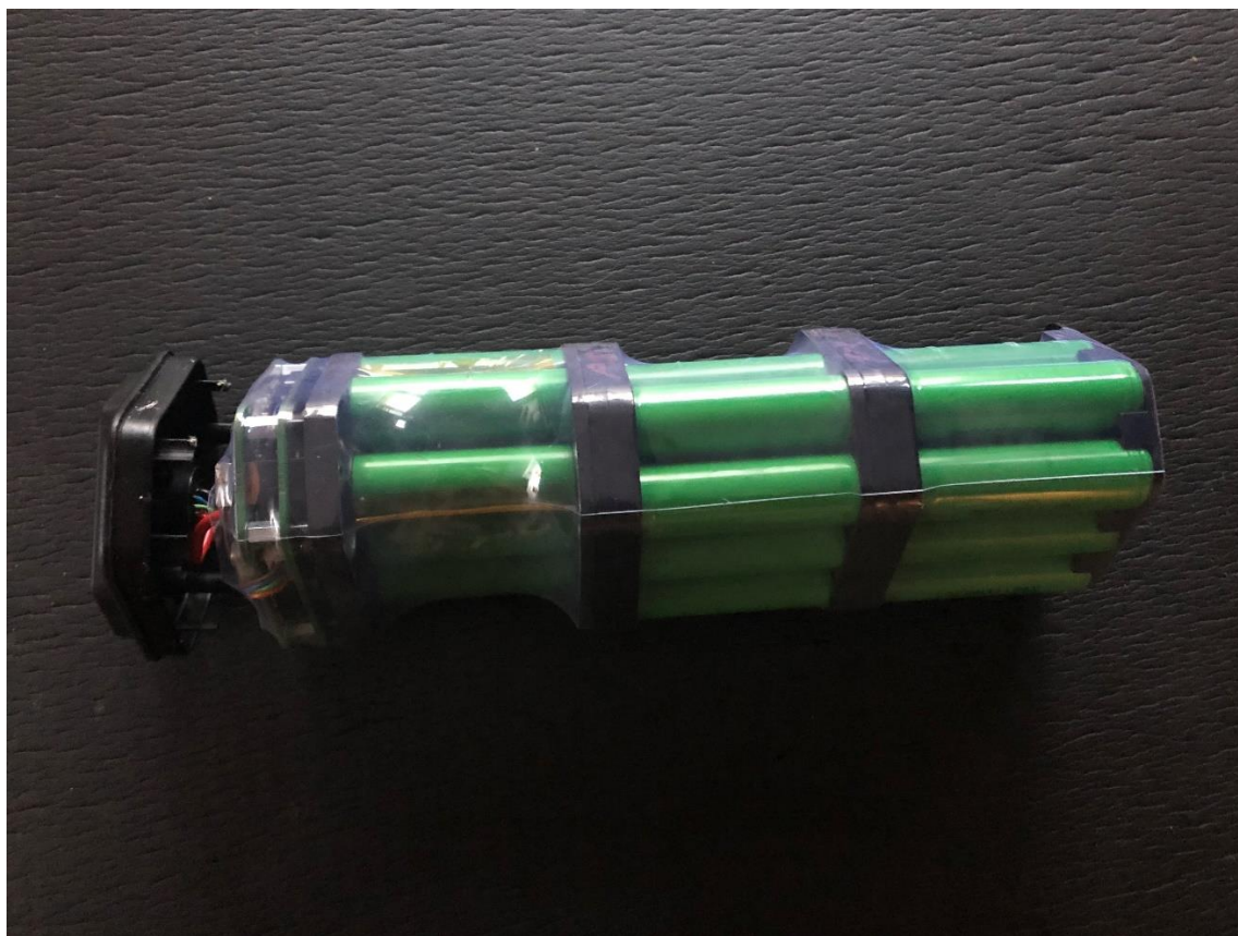
Slika 25. Baterijski paket za mobilni robot
