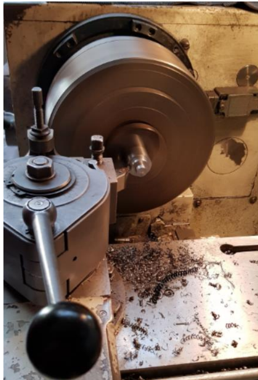
Slika 41. Tokarenje čelične spojke za spoj vratila motora s Wave generatorom
