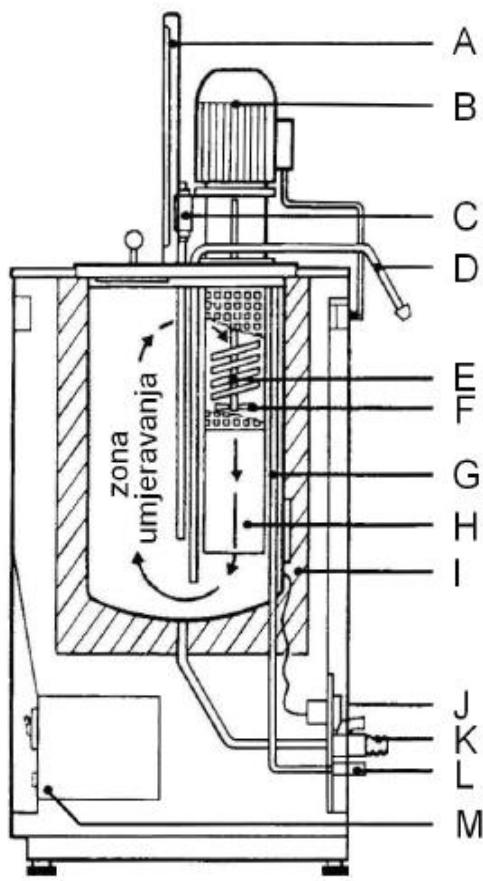
A – kontrolni termometar; B – elektromotor; C – termometar (TEPOT 21); D – priključak za rashladni medij; E – grijači; F – mješalica; G – posuda za radni medij kupke od nehrđajućeg čelika; H – cijev za usmjeravanje protoka; I – izolacija; J – sigurnosni termostat; K – odvod za pražnjenje kupke; L – odvod za višak tekućine; M – regulator temperature
