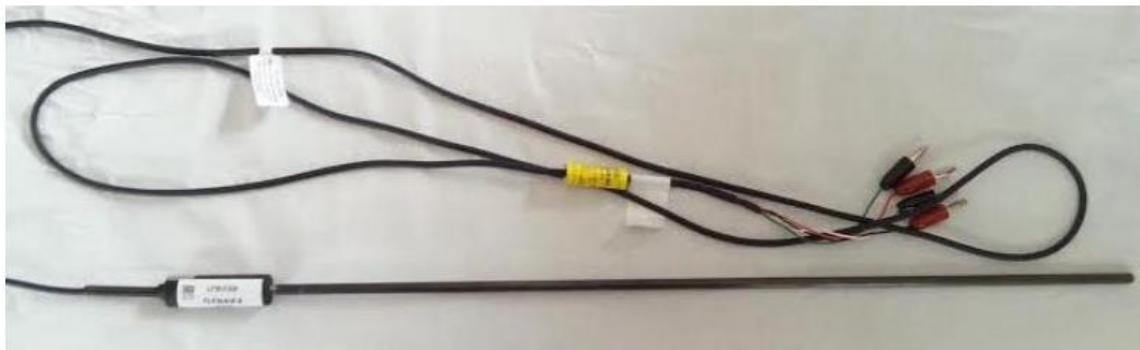
Slika 9. Otpornički termometri korišteni za umjeravanje kupke
