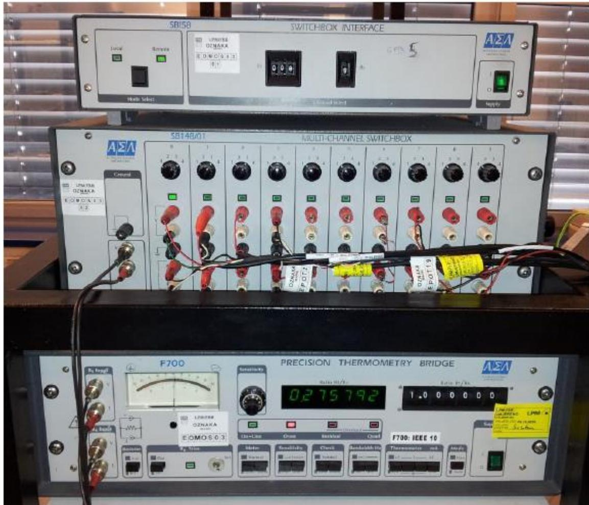
Slika 10. Termometrijski otpornički most F700
