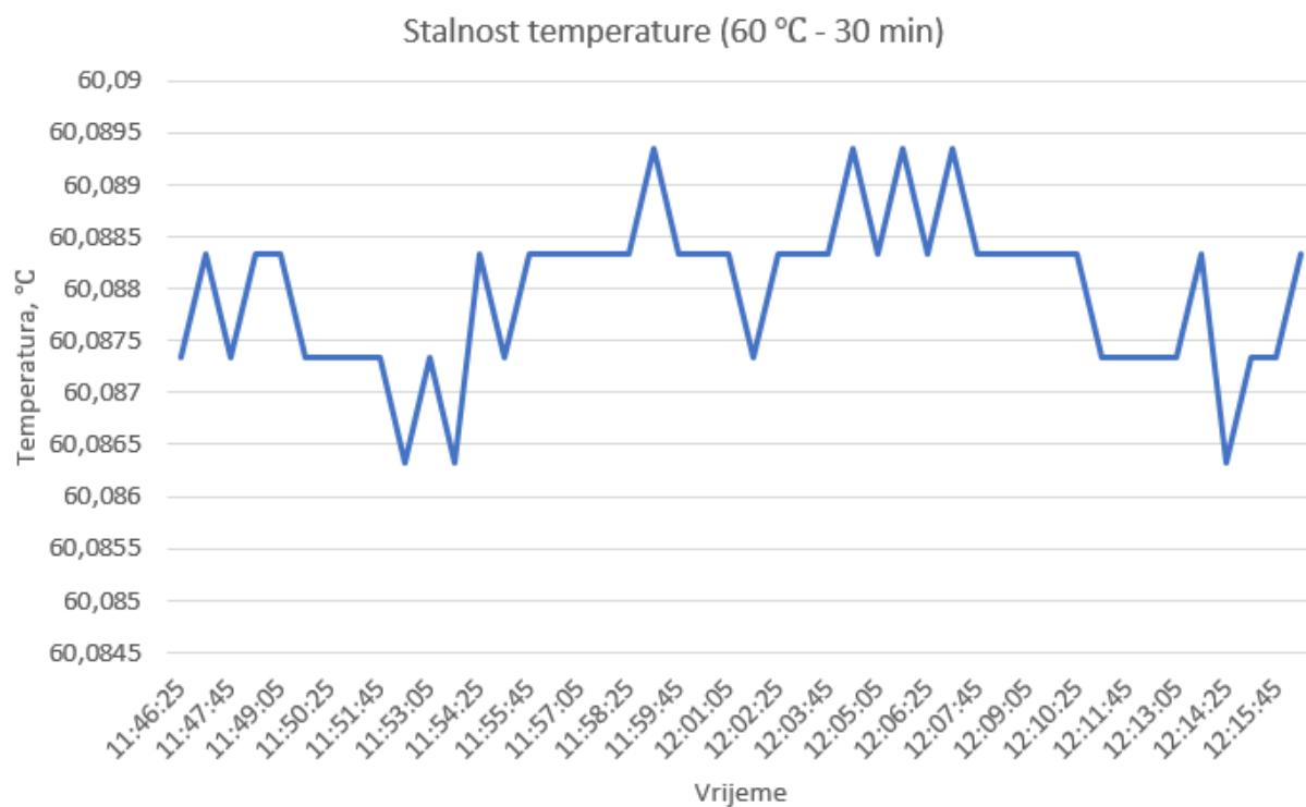
**Slika 13.** 30 minutna stalnost temperature pri 60 °C
