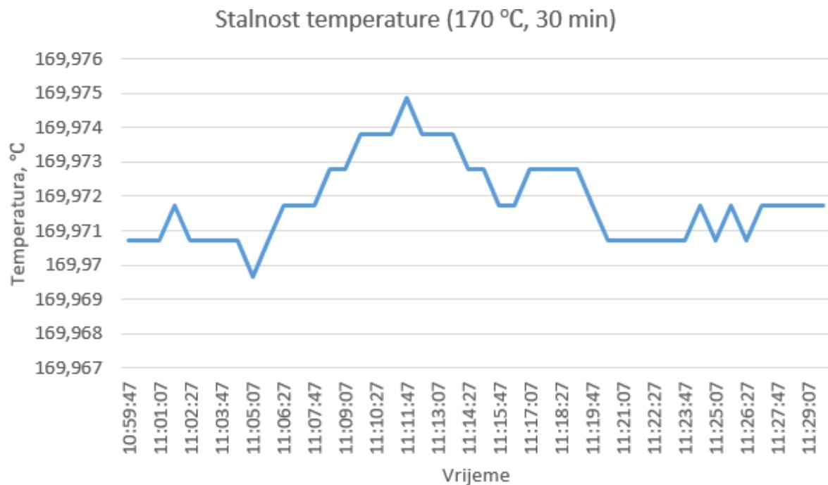
Slika 15. 30 minutna stalnost temperature pri 170 °C
