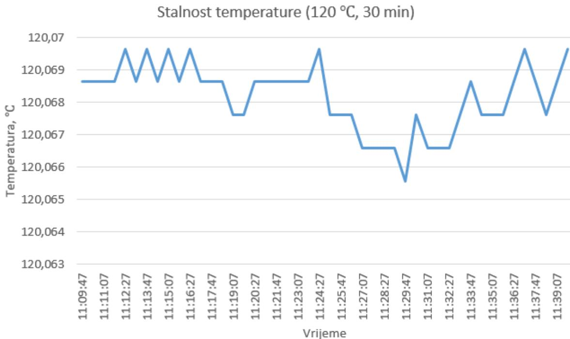
**Slika 14.** 30 minutna stalnost temperature pri 120 °C
