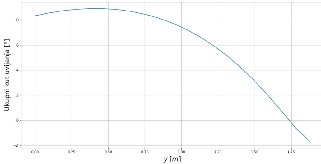
Slika 3.2: Zbroj aerodinamičkog i geometrijskog uvijanja
