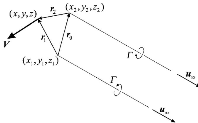
Slika 2.2: Brzina u točki  $(x,y,z)$  inducirana  $\Pi$  vrtlogom
