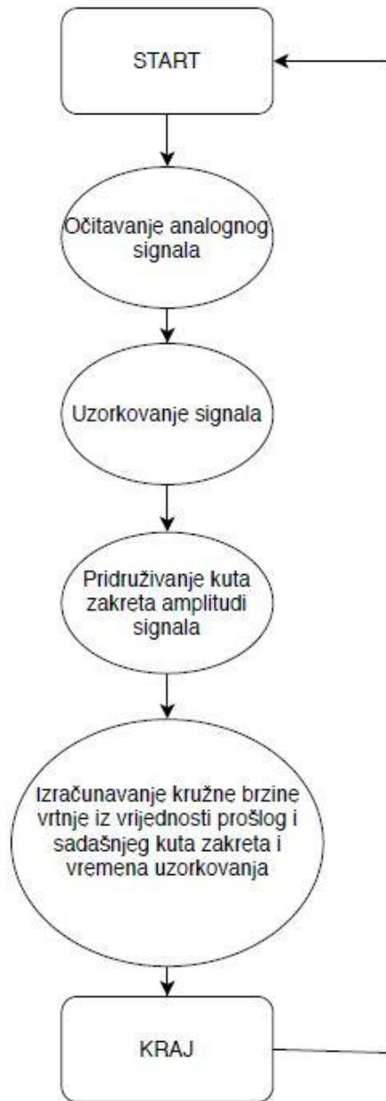
**Slika 32. Algoritam za mjerjenje brzine vrtnje vratila elektromotora**
