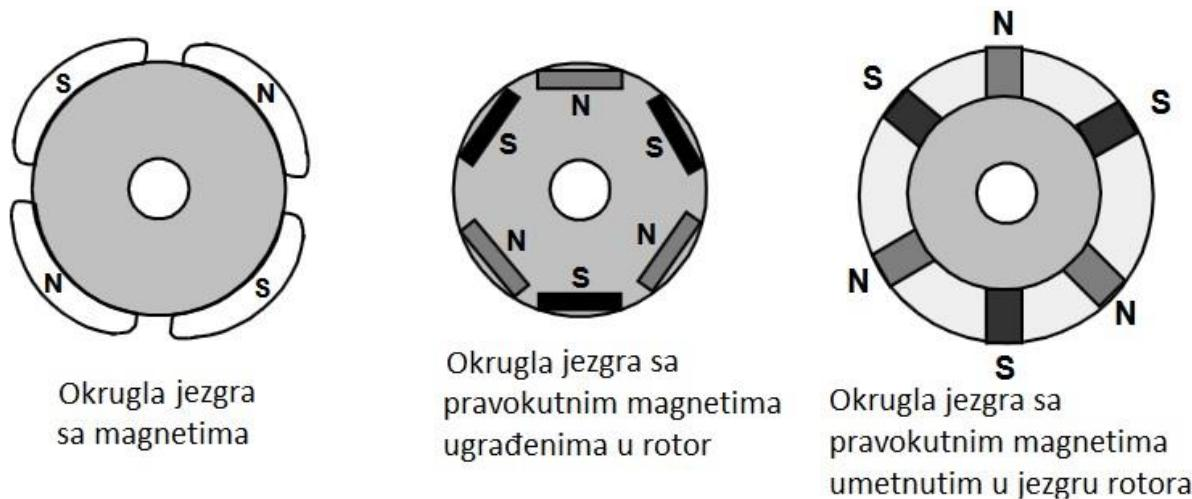
**Slika 13. Poprečni presjek rotora BLDC elektromotora [10]**
